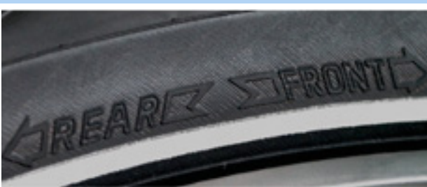
64 paveikslėlis. Krypties rodyklė ant MTB padangų
