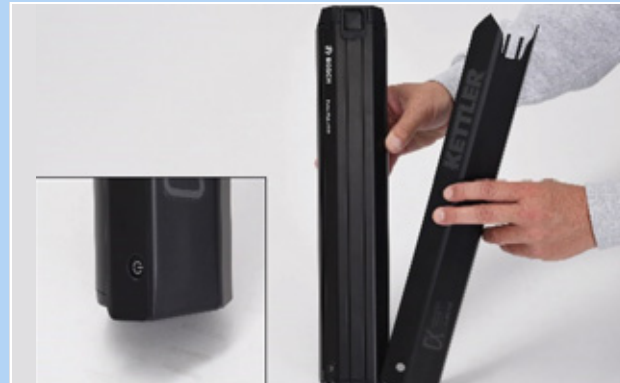
58 paveikslėlis. Akumuliatoriaus dangtelio užstūmimas ant akumuliatoriaus
