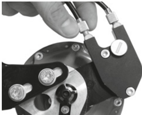
150 paveikslėlis. „Rohloff“ stebulės variantas su išoriniu perjungimo valdymu turi traukimo reguliatorius ant kabelių dėžės, kuri yra kairėje
