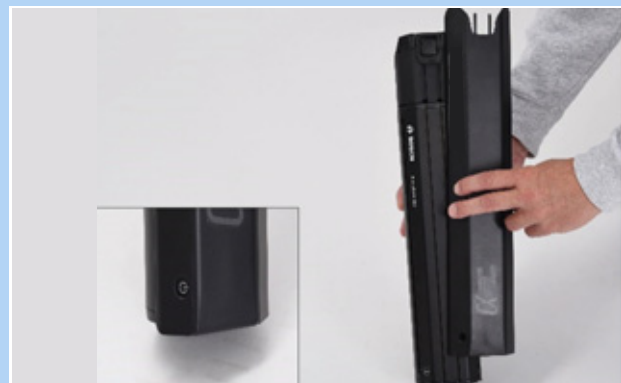
62 paveikslėlis. Akumulatoriaus dangtelio užstūmimas ant akumulatoriaus
