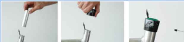
214 paveikslėlis. Sumontuokite slankiąją įvorę ir išorinę movą
