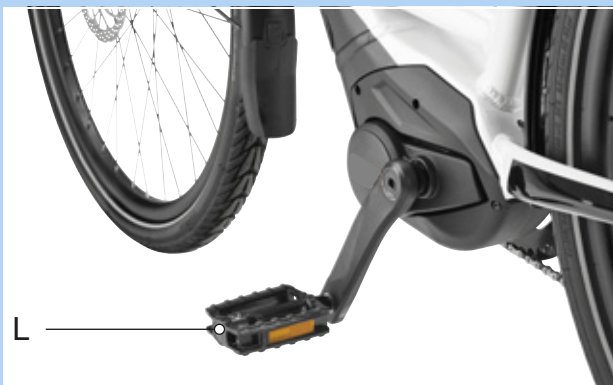
80 paveikslėlis. L pedalas kairiojoje alkūninėje svirtyje
