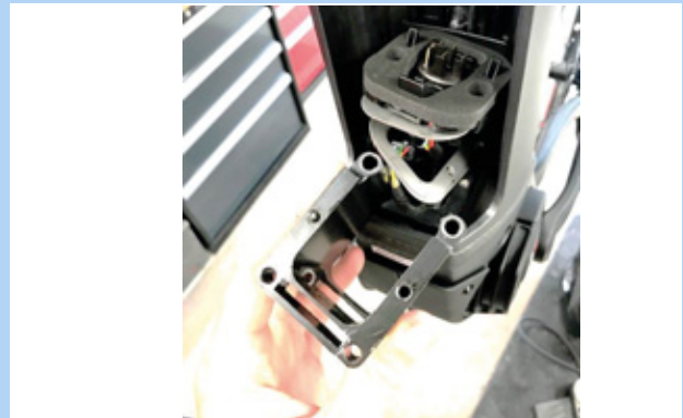
53 paveikslėlis. „PowerTube Adapter“ ištraukimas
