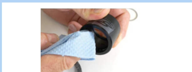
169 paveikslėlis. Išvalykite išorinę movą
