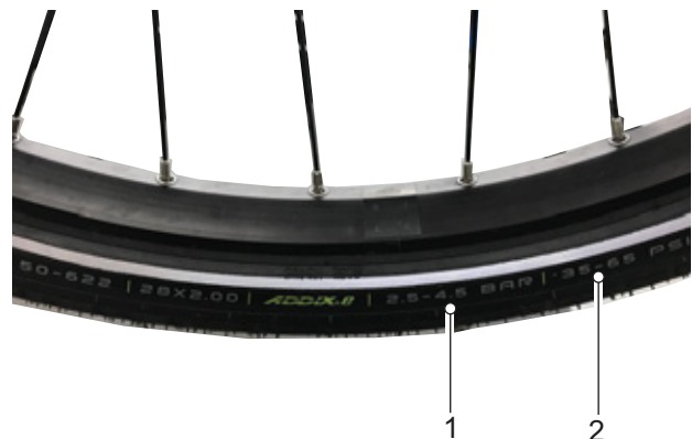
143 paveikslėlis. Užpildymo slėgis barais (1) ir psi (2)
