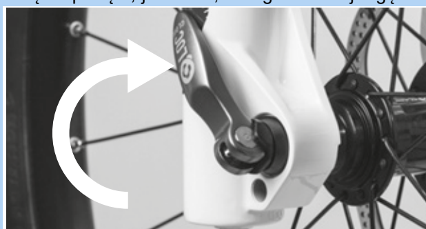
78 paveikslėlis. Ekscentriko uždarymas
