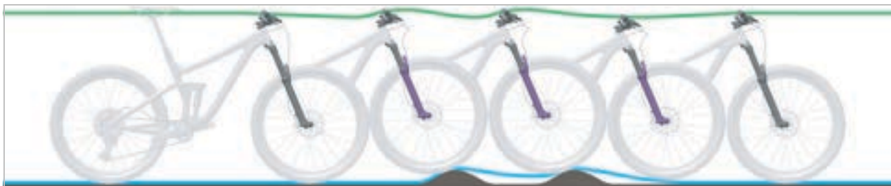
Figura 242: Corsa di estensione troppo lenta della forcella ammortizzata
