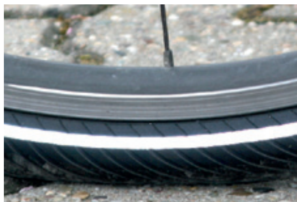
Figura 119: Corretta pressione di gonfiaggio. Lo pneumatico quasi non si deforma sotto il peso corporeo
