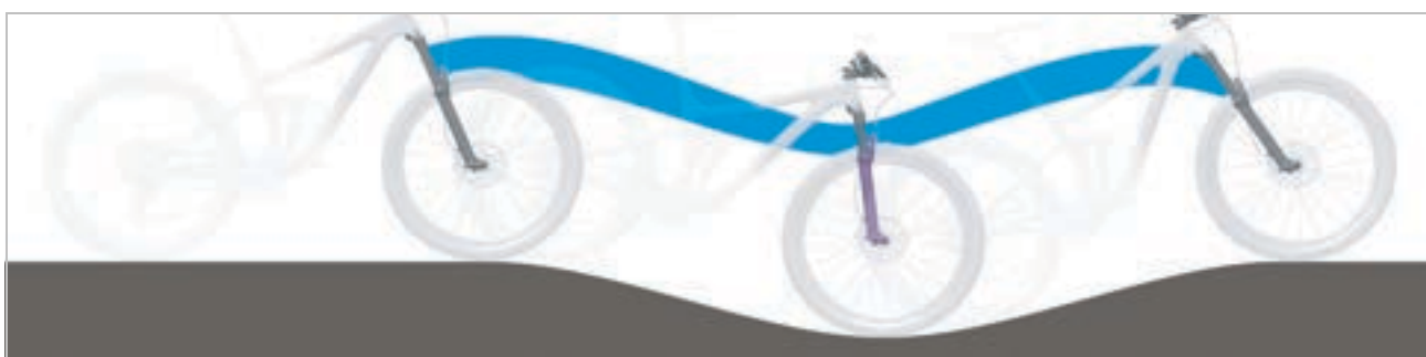
Figura 167: Comportamento di marcia ottimale su un terreno con dossi
