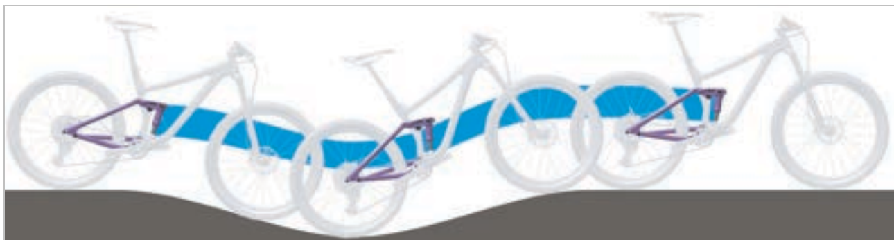
Figura 6: Comportamento di marcia ottimale dell'ammortizzatore del carro posteriore su un terreno con dossi
