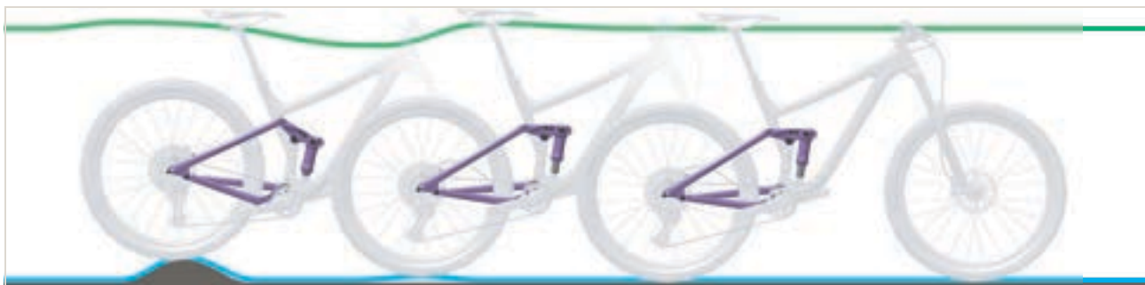
Figura 264: Corsa di estensione troppo veloce dell'ammortizzatore del carro posteriore
