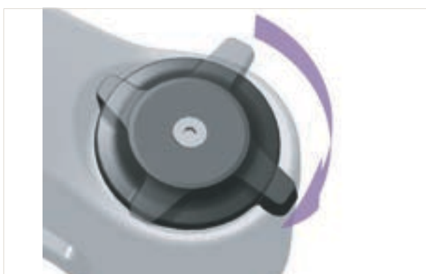
Figura 237: Regolazione più rigida del regolatore dello stadio di compressione
