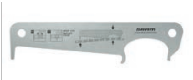
Figura 204: Esempio di calibro di misura dell'usura SRAM
