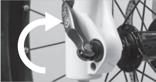
Figura 87: Chiusura del bloccaggio rapido
