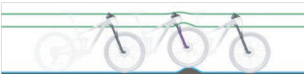
Figura 17: Comportamento di marcia ottimale della forcella su un terreno con asperità
