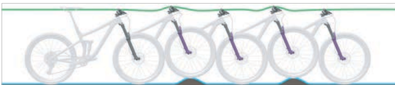
Figura 22: Comportamento di marcia ottimale della forcella
