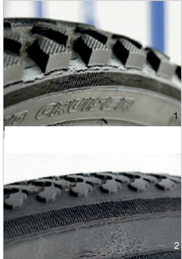
Figura 199: Esempi di crepe da fatica (1) e da invecchiamento (2)
