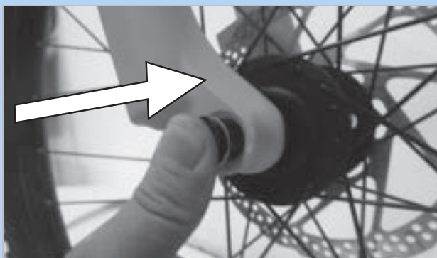
Figura 74: Insetimento del perno nel verso della freccia
