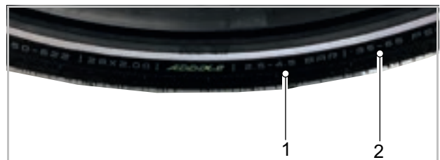
Figura 197: Pressione di gonfiaggio in bar (1) e in psi (2)
