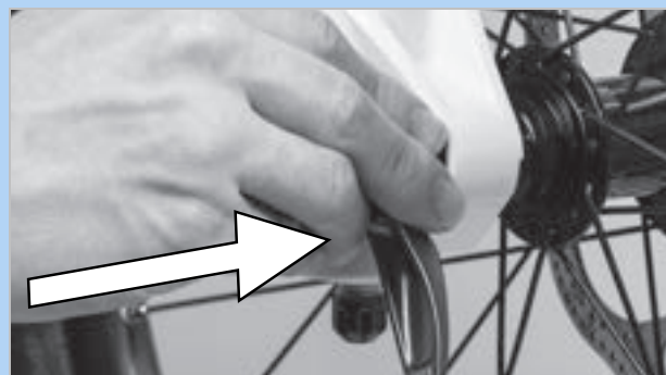
Figura 85: Inserimento del bloccaggio rapido nel verso della freccia
