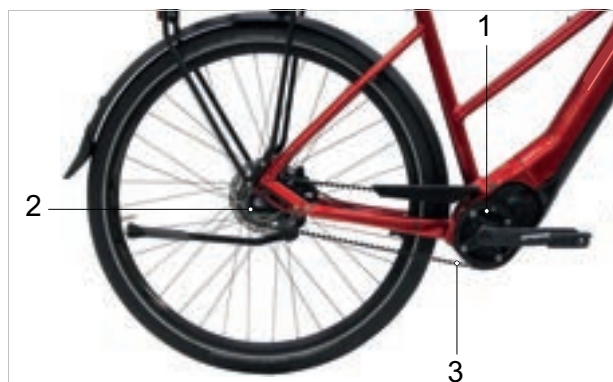
Figura 46: Schema della trasmissione a cinghia
