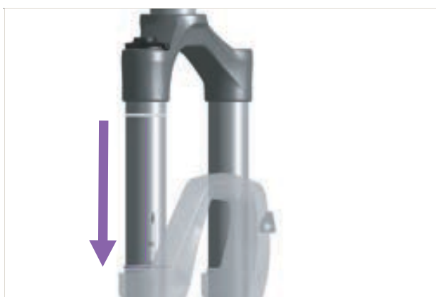
Figura 135: Spostamento dell'O-ring sulla forcella ammortizzata
