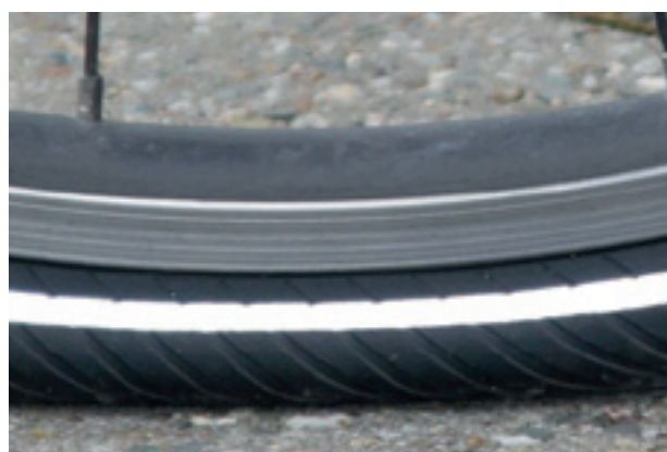
Figura 120: Pressione di gonfiaggio insufficiente
