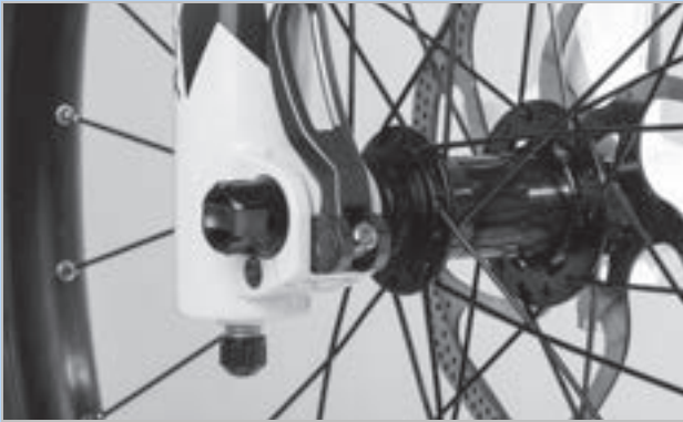
Figura 228: Regolazione della forza di serraggio del bloccaggio rapido
