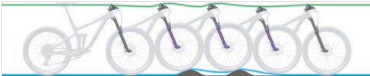
Figura 248: Corsa di estensione troppo lenta della forcella ammortizzata
