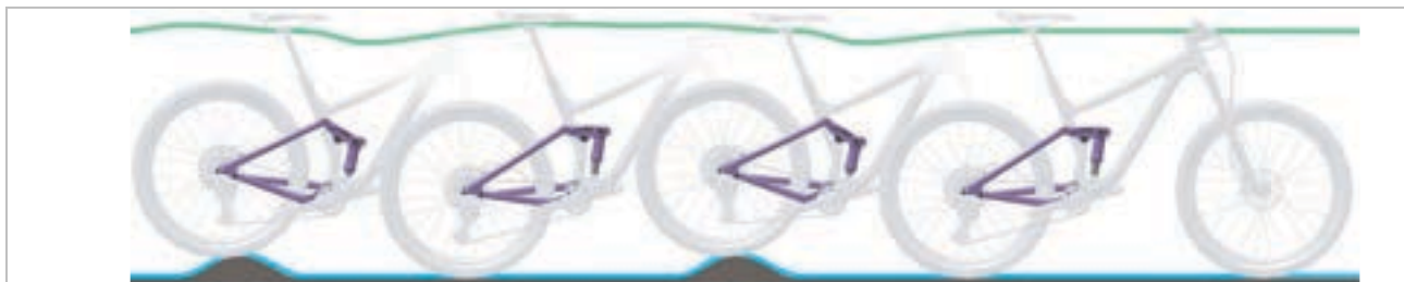
Figura 139: Comportamento di marcia ottimale dell'ammortizzatore del carro posteriore
