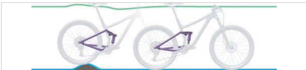
Figura 141: Comportamento di marcia ottimale dell'ammortizzatore del carro posteriore su asperità
