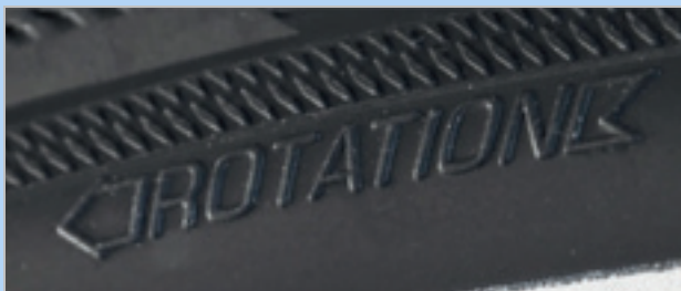
Figura 71: Freccia del senso di rotazione
