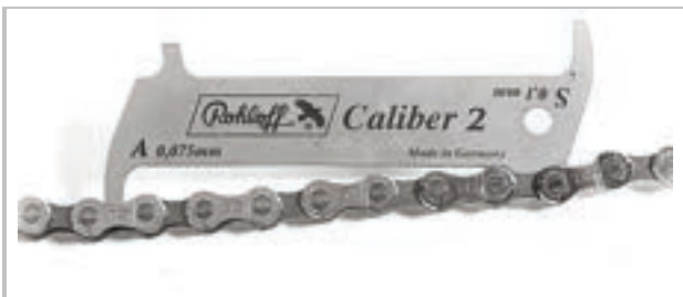
Figura 205: Esempio di calibro di misura dell'usura ROHLOFF
