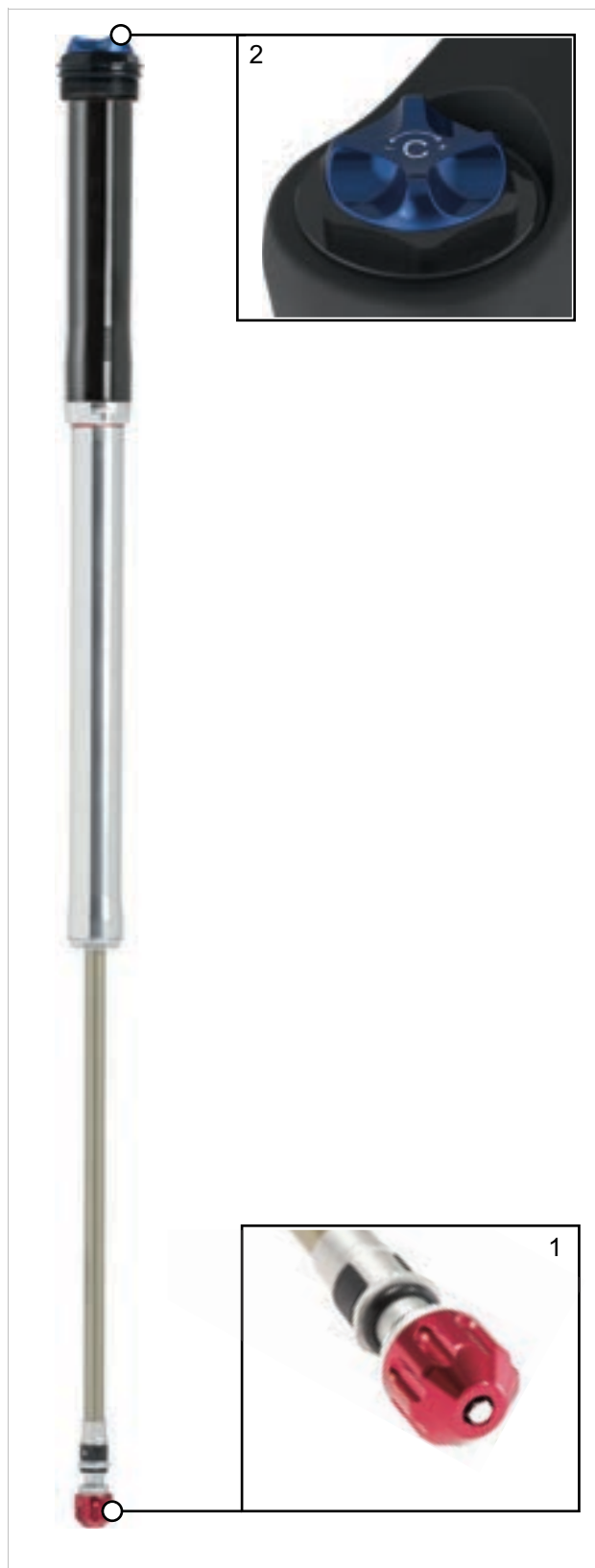
Figura 30: Terminali di comando di RC
