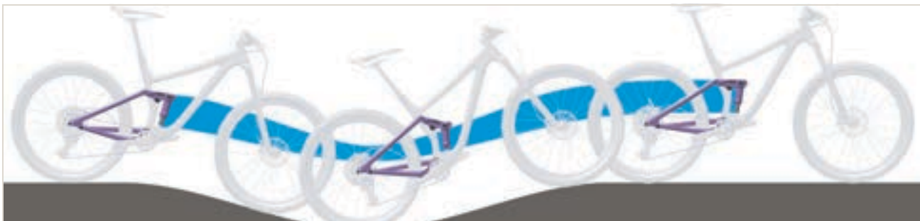
Figura 276: Sospensione dell'ammortizzatore del carro posteriore troppo morbida in salita
