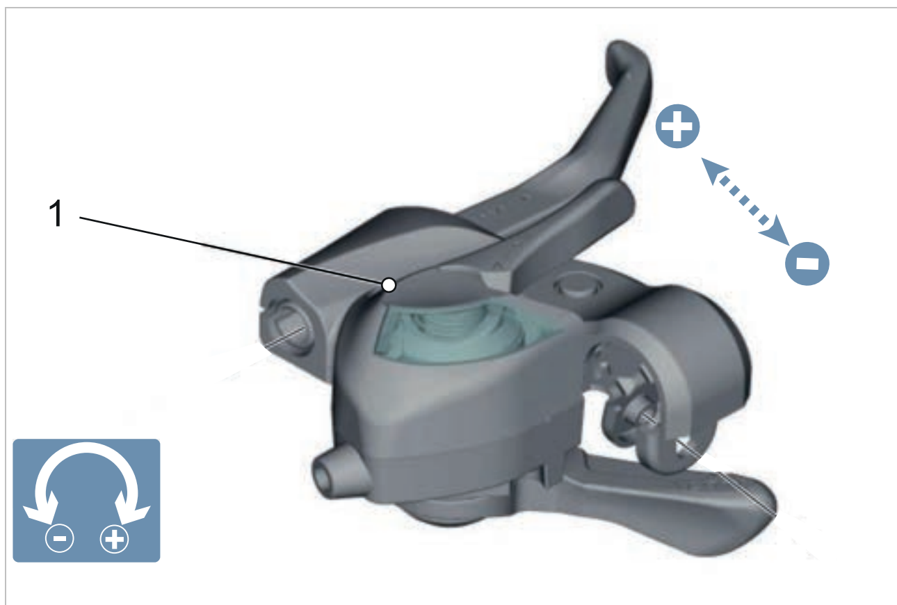
Figura 125: Posizione della vite di regolazione (1)
