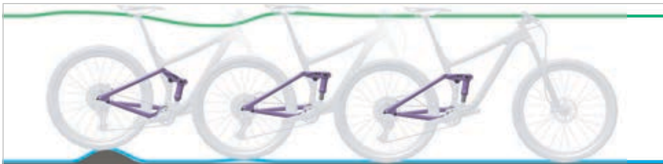
Figura 256: Corsa di estensione troppo veloce dell'ammortizzatore del carro posteriore
