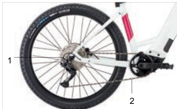
Figura 45: Schema della struttura a catena con cambio a catena
