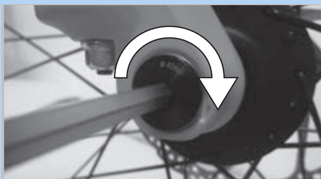
Figura 75: Serraggio del perno nel verso della freccia
