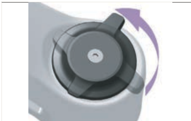
Figura 239: Regolazione più morbida del regolatore dello stadio di compressione
