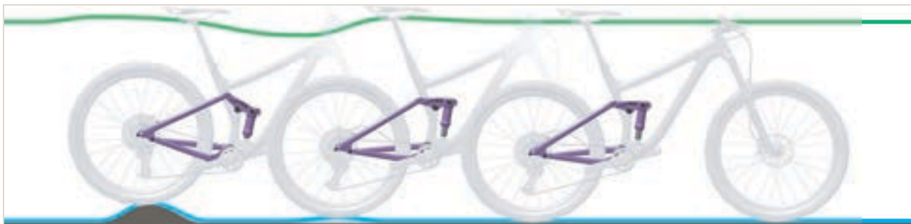
Figura 272: Corsa di estensione troppo veloce dell'ammortizzatore del carro posteriore
