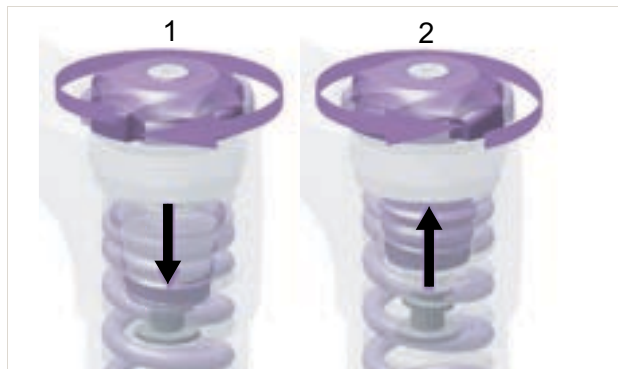
Figura 131: Avvitamento (1) e svitamento (2) della manopola di regolazione della SAG
