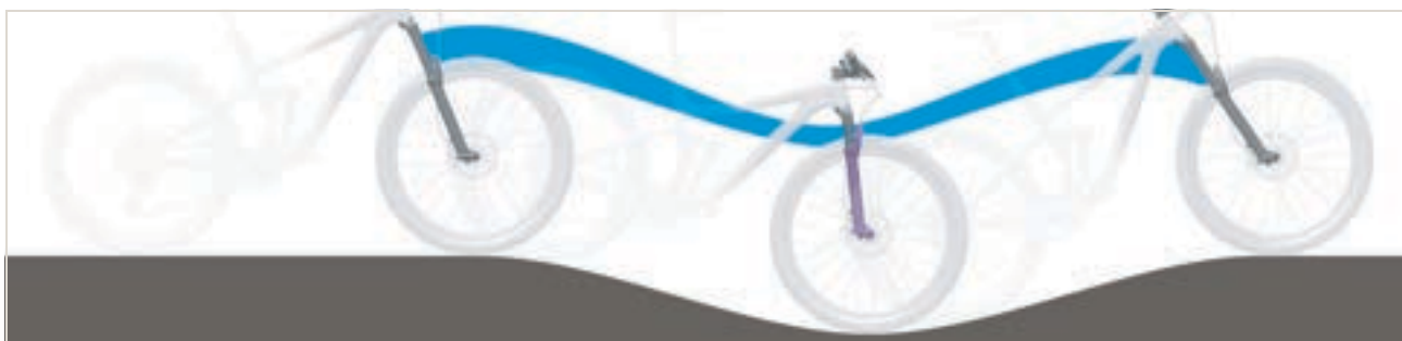
Figura 250: Sospensione della forcella ammortizzata troppo morbida in salita
