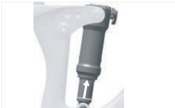
Figura 144: Spostamento dell'O-ring sull'ammortizzatore del carro posteriore
