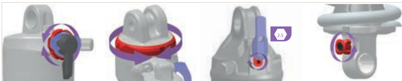
Figura 275: Ubicazione e forma del regolatore del rebound (rosso) in funzione del modello
