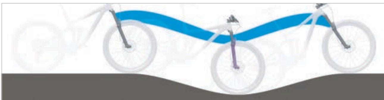
Figura 16: Comportamento di marcia ottimale della forcella su un terreno con dossi
