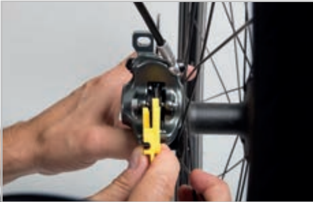
Figura 200: Controllo della guarnizione del freno nello stato montato mediante la sicura di trasporto
