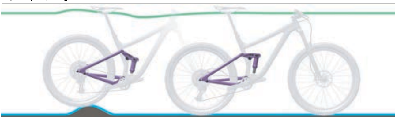
Figura 171: Comportamento di marcia ottimale dell'ammortizzatore del carro posteriore su asperità
