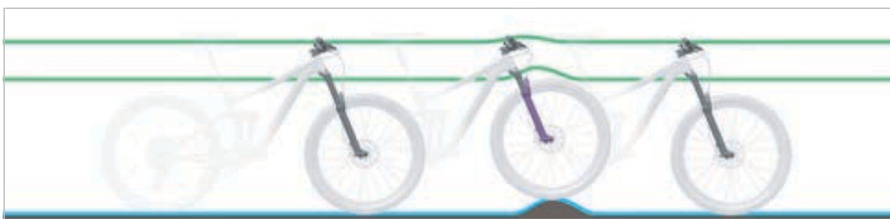
Figura 130: Comportamento di marcia ottimale della forcella su un terreno con asperità
