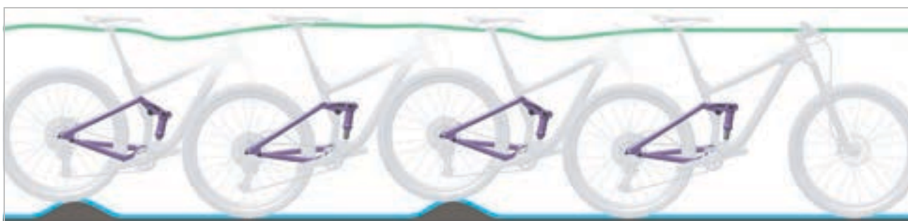
Figura 151: Comportamento di marcia ottimale dell'ammortizzatore del carro posteriore
