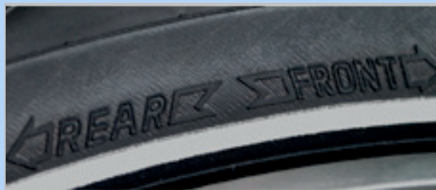
Figura 72: Freccia del senso di rotazione su pneumatici MTB
