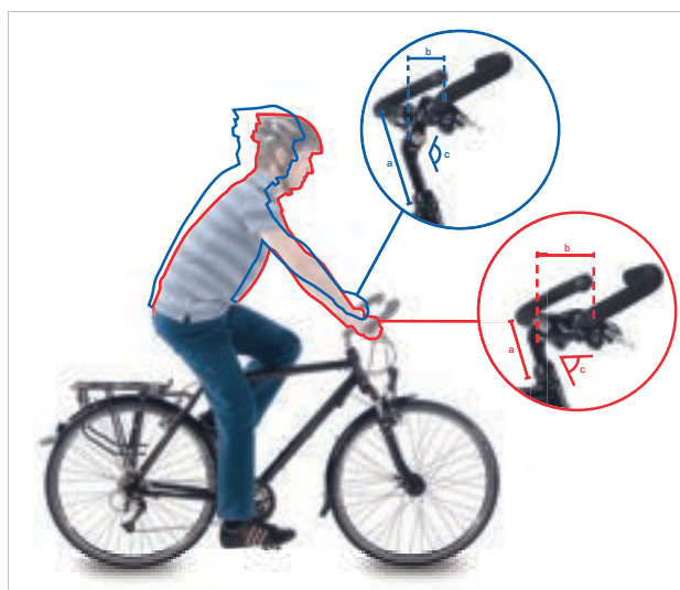
Figura 117: Posizione per bicicletta da città (blu) e per bicicletta da trekking (rosso) tramite modifica dell'angolo
