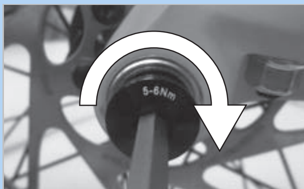
Figura 77: Serraggio della vite di sicurezza
