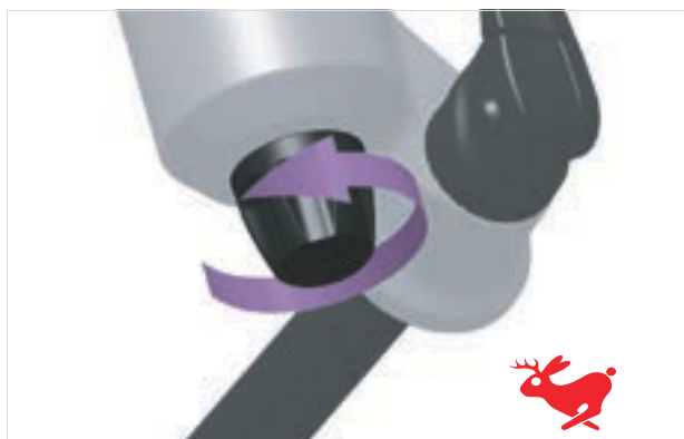
Figura 235: Ruotare il regolatore del rebound (forcella) in direzione della lepre
