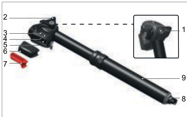
Figura 39: Struttura del canotto reggisella ROCKSHOX Reverb AXS
