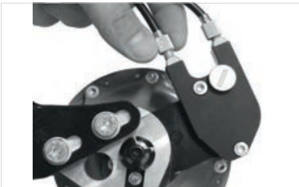
Figura 225: Le versioni del mozzo ROHLOFF con comando esterno del cambio hanno i regolatori del tensionamento sulla scatola dei cavi situata sul lato sinistro
