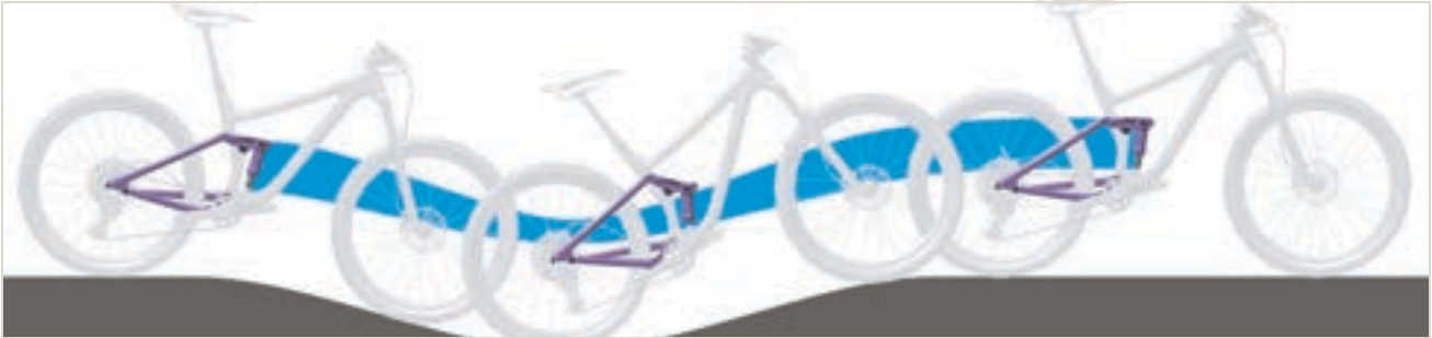
Figura 268: Sospensione dell'ammortizzatore del carro posteriore troppo morbida in salita
