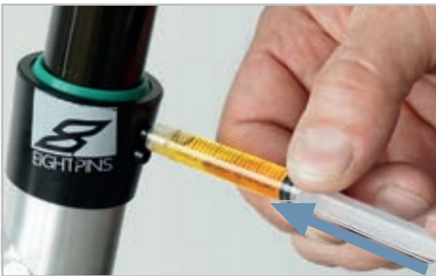
Figura 196: Lubrificazione del cannotto reggisella EIGHTPINS
