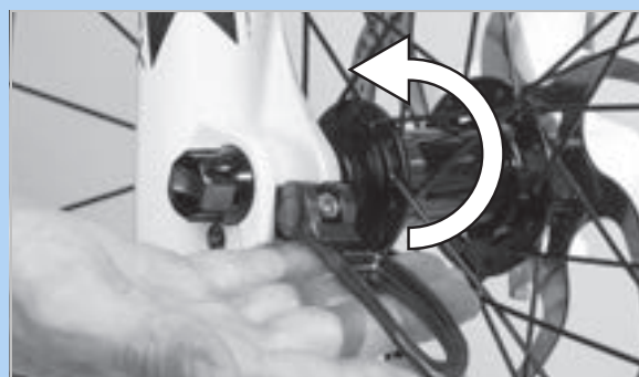
Figura 81: Spinta della leva del bloccaggio rapido nel verso della freccia
