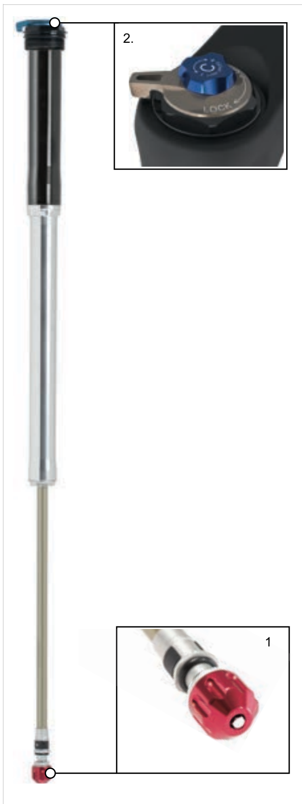
Figura 31: Terminali di comando di RL
