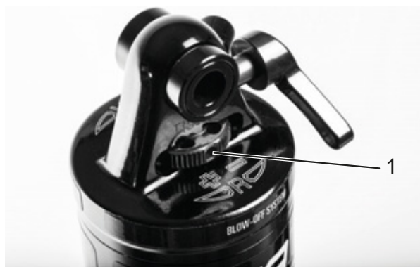
Afbeelding 59: Wiel (1) van de trekdemperafsteller Suntour op de achterbouwdemper
