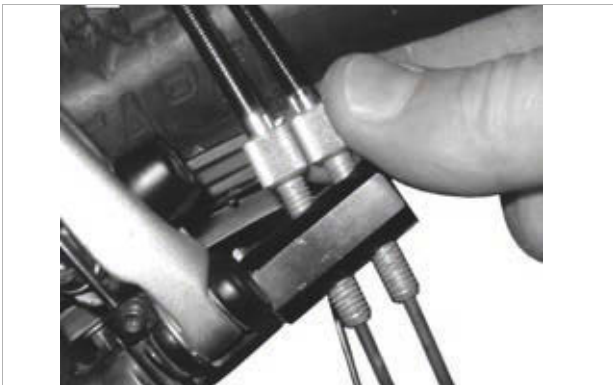
Afbeelding 224: Bij ROHLOFF naafversies met interne schakelaansturing zit de kabelafsteller op de tegenhouder van de kabel
