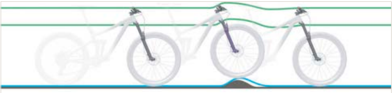
Afbeelding 253: Te harde demping de verende voorvork bij oneffenheden
