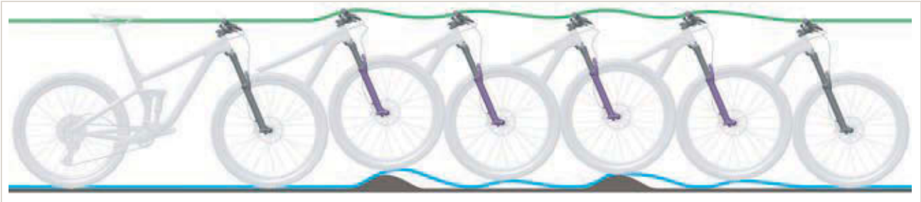
Afbeelding 246: Te snel uitveren van de verende voorvork
