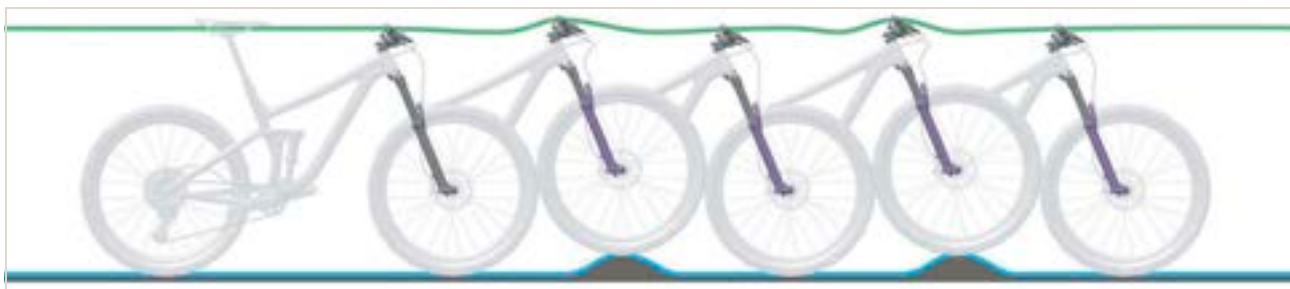
Afbeelding 147: Optimaal rijgedrag van de vork
