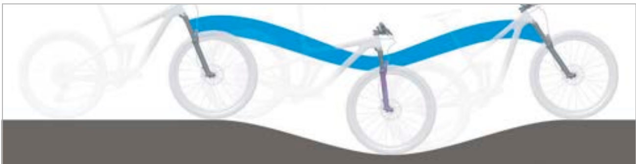
Afbeelding 16: Optimaal rijgedrag van de vork in heuvelachtig terrein
