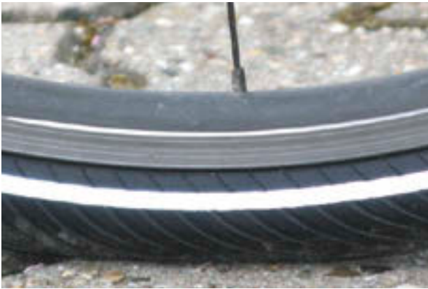
Afbeelding 119: Juiste vuldruk. De band is onder de belasting van het lichaamsgewicht nauwelijks vervormd
