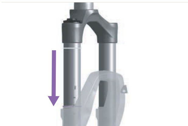
Afbeelding 132: O-ring op de verende voorvork verschuiven
