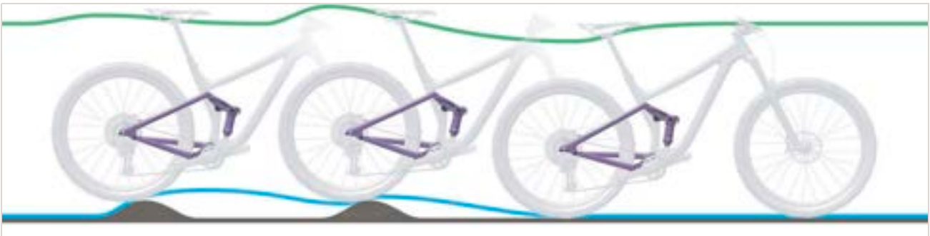
Afbeelding 274: Te langzaam uitveren van de achterbouwdemper
