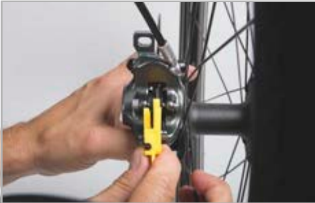
Afbeelding 200: Remvoering in gemonteerde toestand controleren met behulp van de transportbeveiliging
