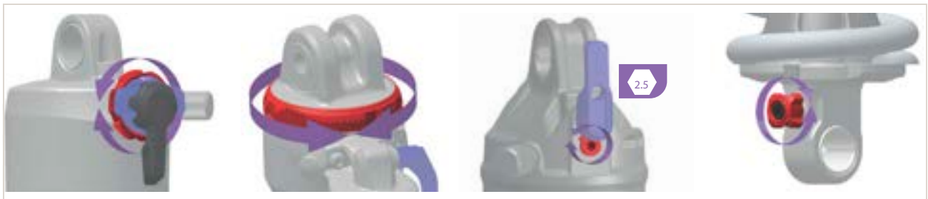
Afbeelding 273: Locatie en vorm van de trekdemperafsteller (achterbouwdeemper) (rood) zijn afhankelijk van het model
