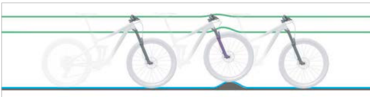
Afbeelding 168: Hard en zacht afgestelde drukdemper
