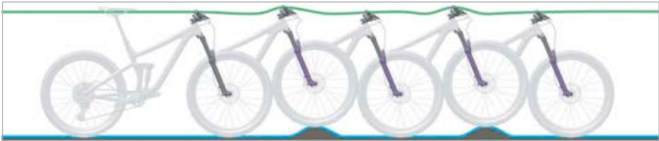
Afbeelding 22: Optimaal rijgedrag van de vork
