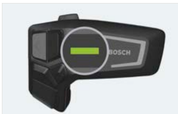
Afbeelding 160: Knipperende LED's op de LED Remote
