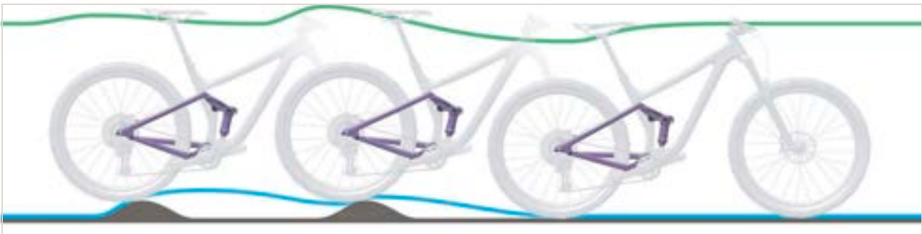
Afbeelding 266: Te langzaam uitveren van de achterbouwdemper
