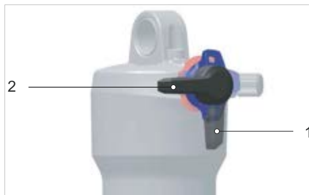
Afbeelding 164: Open stand (1) en drempelstand (2) van de drukdemperafsteller (zwart)
