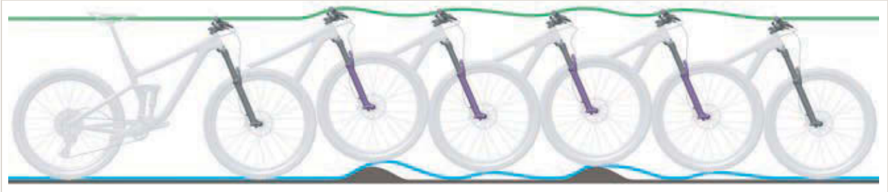
Afbeelding 232: Te snel uitveren van de verende voorvork
