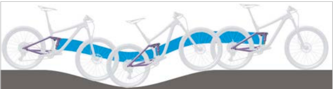
Afbeelding 6: Optimaal rijgedrag van de achterbouwdemper in heuvelachtig terrein
