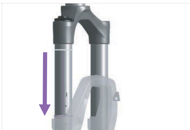
Afbeelding 135: O-ring op de verende voorvork verschuiven
