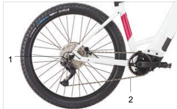
Afbeelding 45: Schema kettingaandrijving met derailleur
