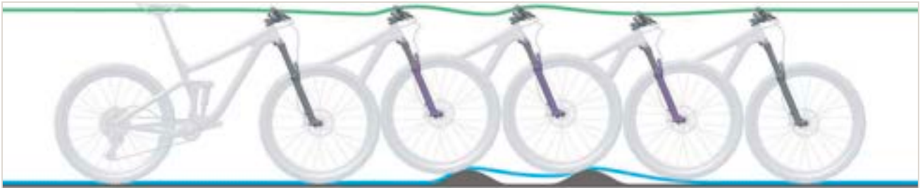
Afbeelding 248: Te langzaam uitveren van de verende voorvork
