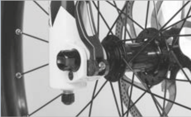
Afbeelding 228: Spankracht van de snelspanner afstellen
