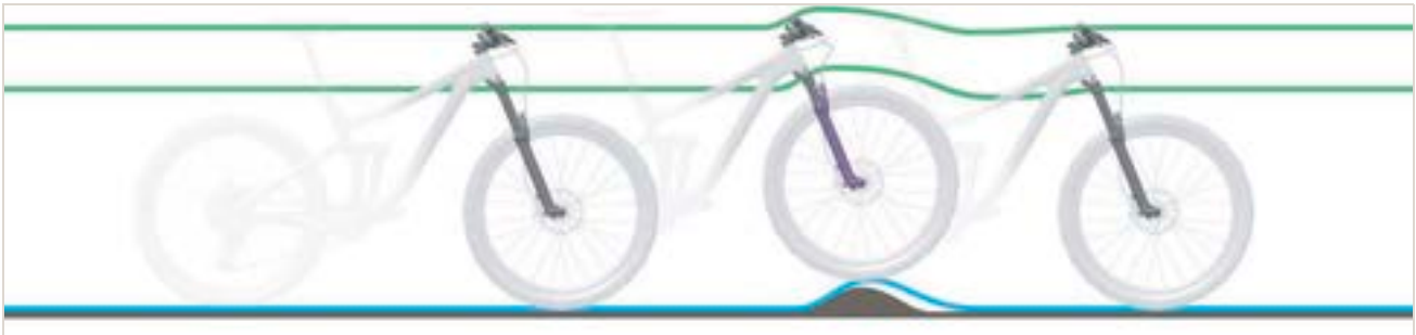
Afbeelding 238: Te harde demping de verende voorvork bij oneffenheden
