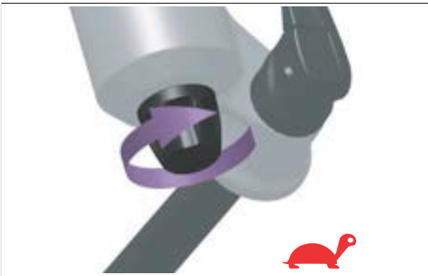
Afbeelding 233: Draai de trekdemperafsteller (vork) in de richting van de schildpad
