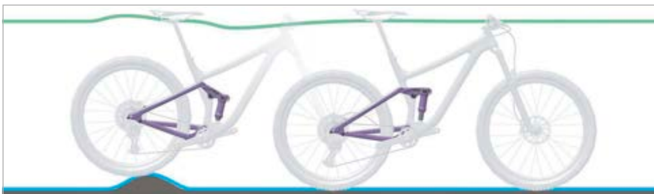
Afbeelding 171: Optimaal rijgedrag van de achterbouwdemper bij oneffenheden
