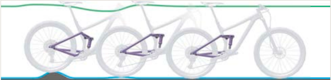
Afbeelding 272: Te snel uitveren van de achterbouwdeemper
