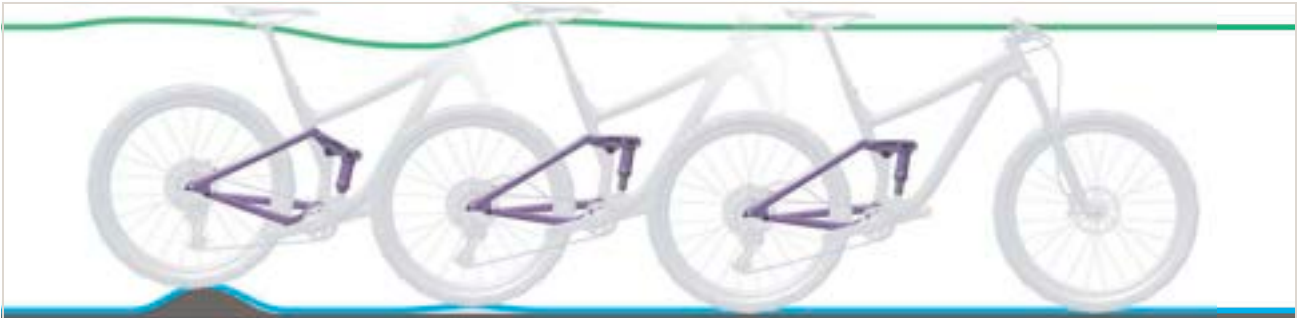
Afbeelding 264: Te snel uitveren van de achterbouwdeemper
