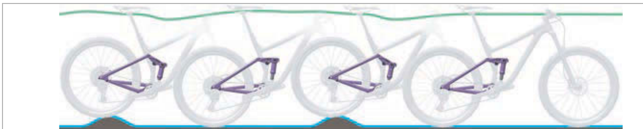
Afbeelding 139: Optimaal rijgedrag van de achterbouwdeemper
