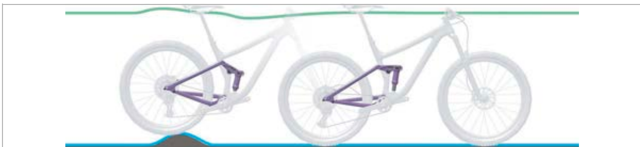
Afbeelding 141: Optimaal rijgedrag van de achterbouwdeemper bij oneffenheden
