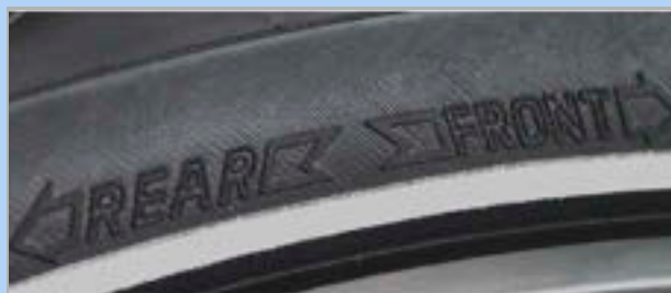
Afbeelding 72: Pijl draairichting op MTB-banden
