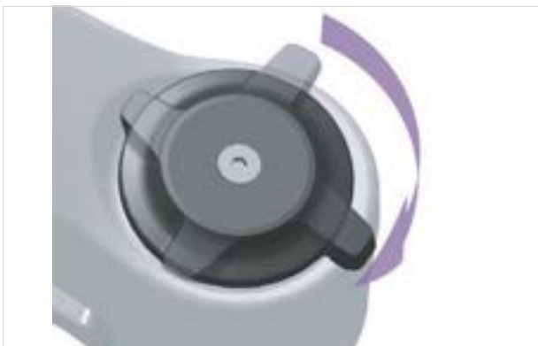
Afbeelding 237: Drukdemperafsteller harder afstellen
