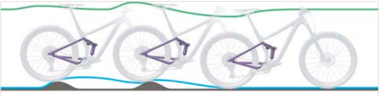
Afbeelding 258: Te langzaam uitveren van de achterbouwdemper
