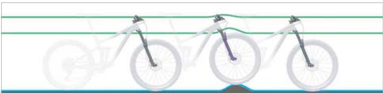
Afbeelding 17: Optimaal rijgedrag van de vork bij oneffenheden
