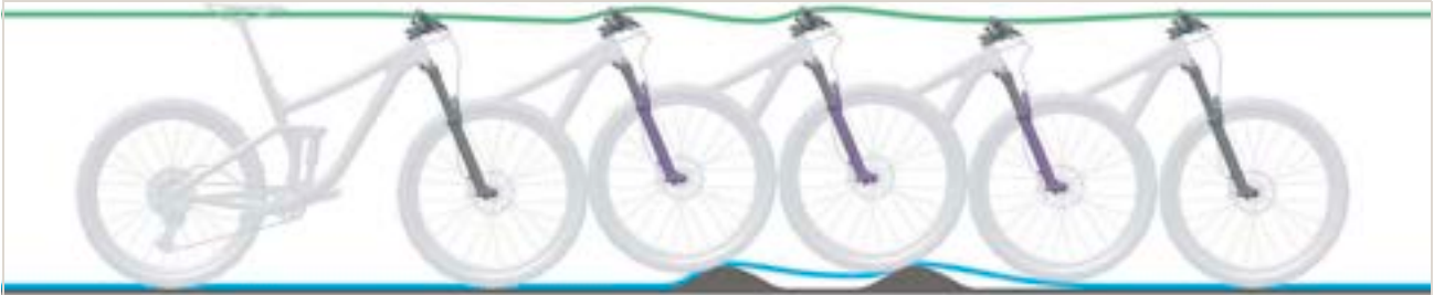
Afbeelding 234: Te langzaam uitveren van de verende voorvork
