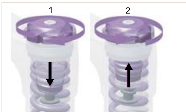
Afbeelding 131: Het afstelwiel sag in- (1) en uitdraaien (2)
