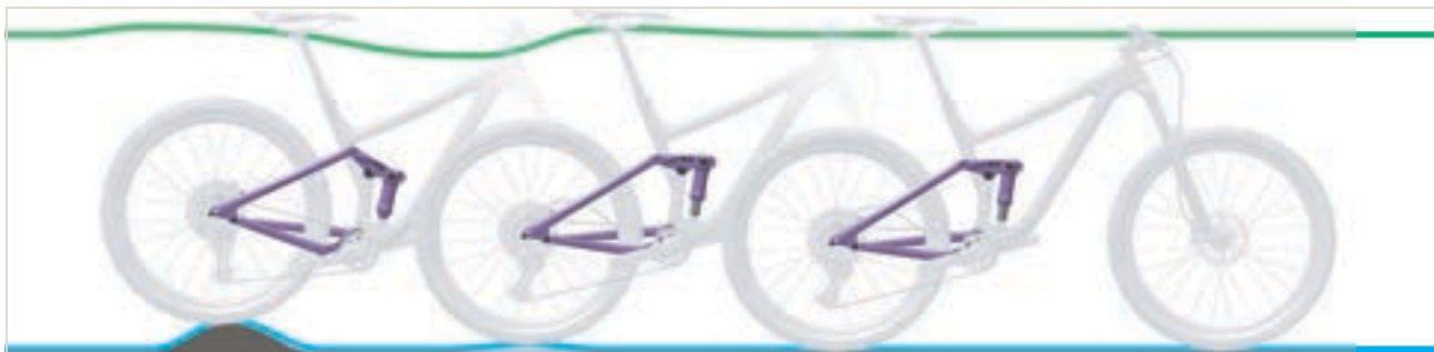
Rysunek 265: Zbyt szybkie rozprężanie się tylnego amortyzatora
