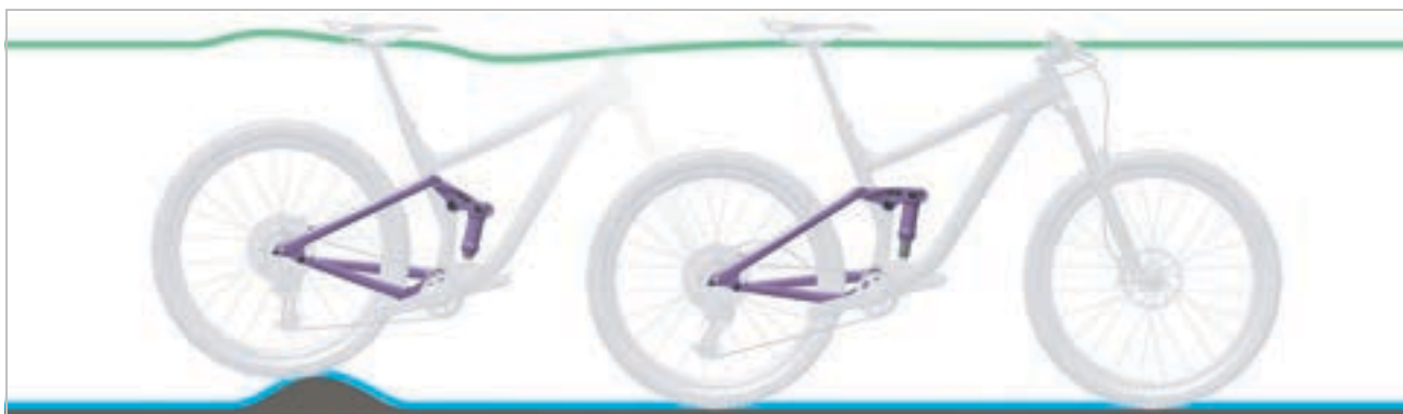
Rysunek 172: Optymalne działanie tylnego amortyzatora na nierównościach
