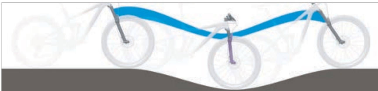
Rysunek 245: Zbyt miękkie amortyzowanie widelca na wzniesieniu
