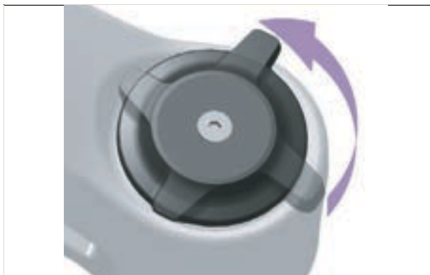
Rysunek 240: Wyregulować nastawnik dobicia tak, aby amortyzator był bardziej miękki
