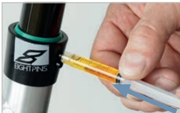
Rysunek 197: Smarowanie sztycy podsiodłowej EIGHTPINS
