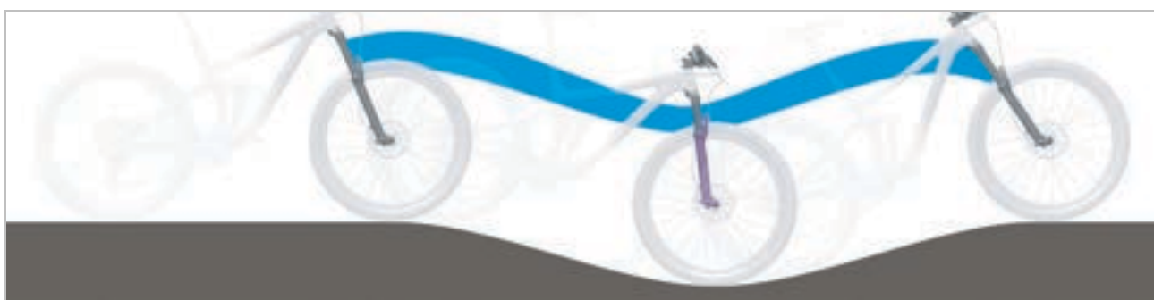
Rysunek 16: Optymalne działanie widełca na pagórkowatym terenie
