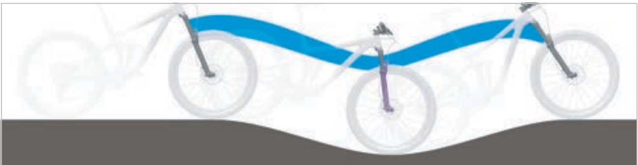
Rysunek 130: Optymalne działanie widełca na pagórkowatym terenie
