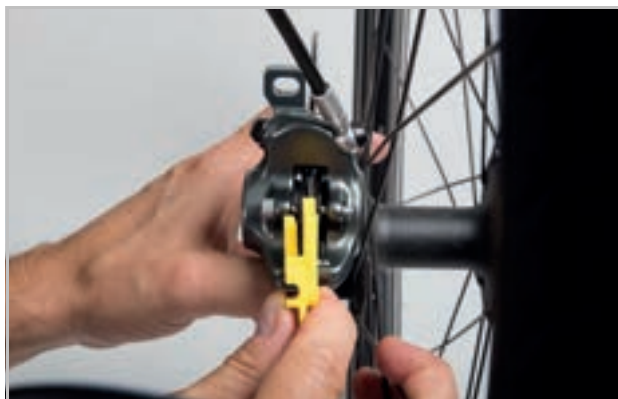
Rysunek 201: Sprawdzać stan klocków hamulca w stanie zamontowanym za pomocą zabezpieczenia transportowego
