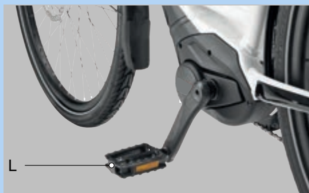
Rysunek 93: Pedał „L” w lewym ramieniu korby
