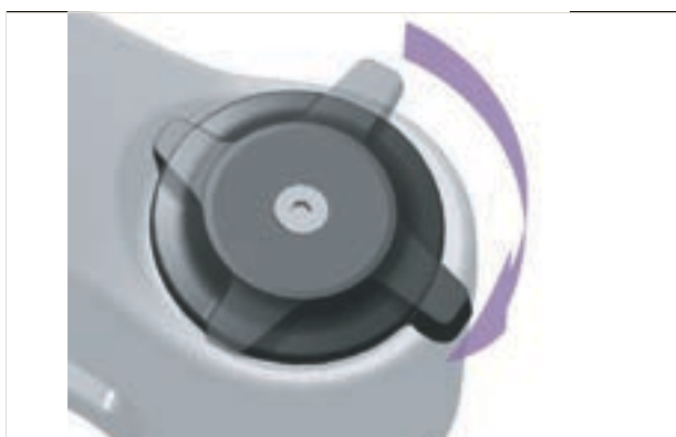
Rysunek 238: Wyregulować nastawnik dobicia tak, aby amortyzator był bardziej twardy
