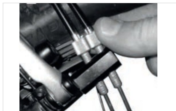
Rysunek 225: Wersje piast ROHLOFF z wewnętrznym sterowaniem zmiany biegów posiadają regulator naprężenia na wsporniku linek
