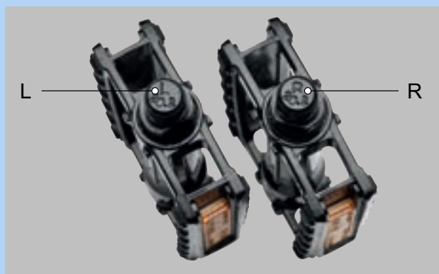
Rysunek 92: Przykład oznaczenia pedałów
