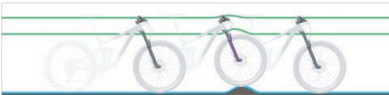
Rysunek 17: Optymalne działanie widełca podczas jazdy po nierównościach
