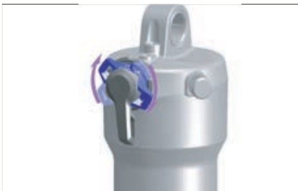
Rysunek 176: Wyregulować nastawnik dobicia tak, aby amortyzator był bardziej twardy
