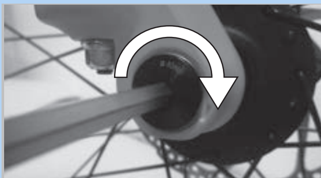
Rysunek 75: Dokręcić oś zgodnie z kierunkiem strzałki
