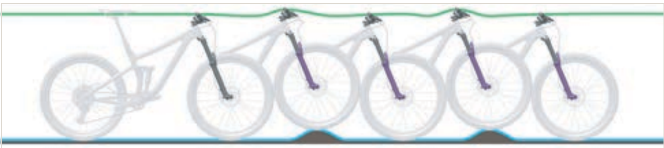
Rysunek 148: Optymalne działanie widelca
