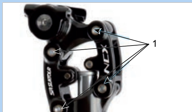
Rysunek 231: Punkty smarowania amortyzowanej sztycy podsiodłowej SR SUNTOUR
