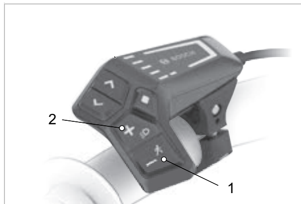
Rysunek 186: Położenie przycisków Plus i Minus
