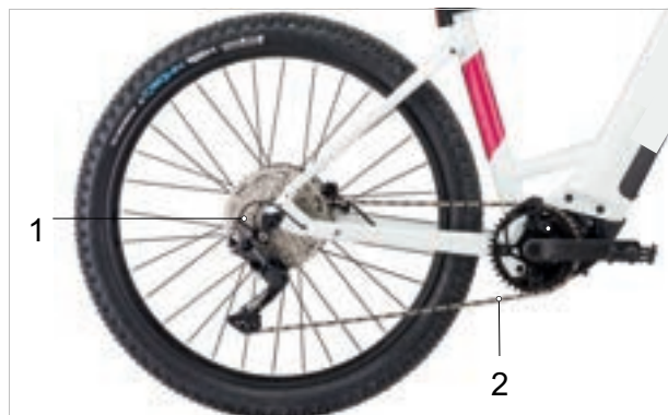
Rysunek 45: Schemat napędu łańcuchowego z przerzutką
