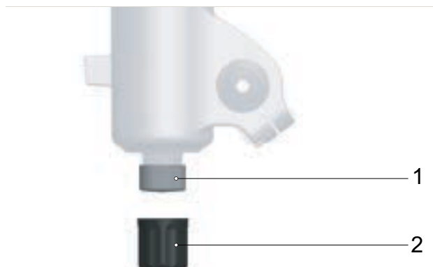
Rysunek 248: Nastawnik odbicia (widelca) (1) pod kapturkiem (2) widelca FOX
