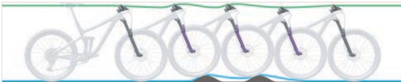
Rysunek 249: Zbyt wolne rozprężanie widelca amortyzowanego
