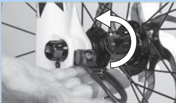
Rysunek 81: Docisnąć dźwignia zacisku szybko mocującego zgodnie z kierunkiem strzałki
