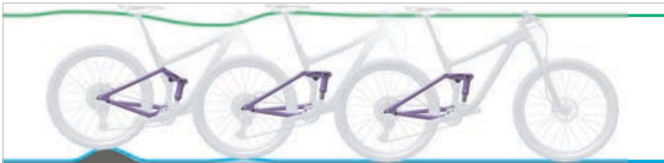
Rysunek 257: Zbyt szybkie rozprężanie się tylnego amortyzatora
