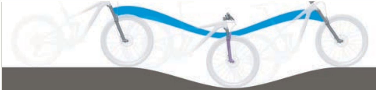
Rysunek 251: Zbyt miękkie amortyzowanie widelca na wzniesieniu
