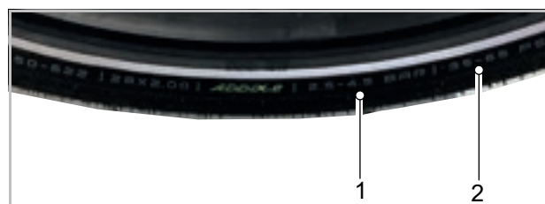
Rysunek 198: Dane ciśnienia w oponach w barach (1) i psi (2)
