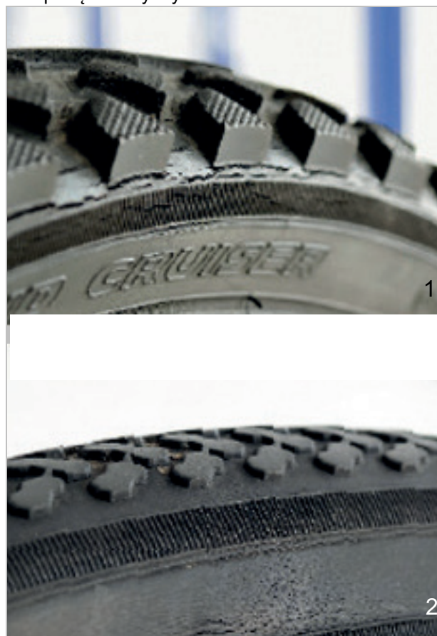
Rysunek 200: Przykłady pęknięć zmęczeniowych (1) i w wyniku starzenia się (2)
