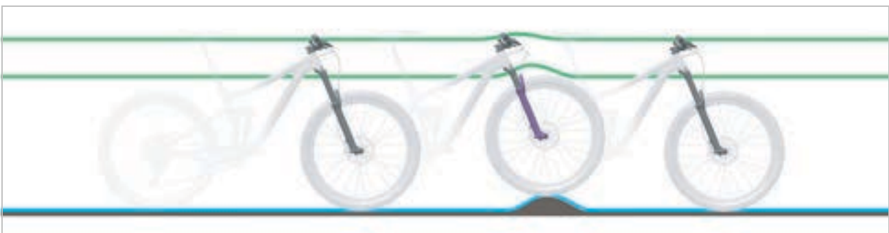
Rysunek 169: Twarde i miękkie ustawienie tłumika dobiecia
