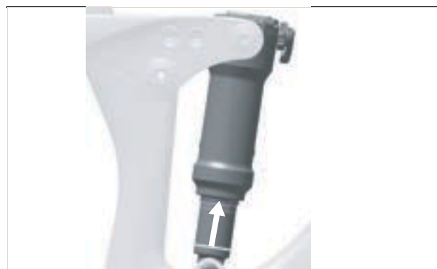
Rysunek 145: Przesuwanie pierścienia o-ring na tylnym amortyzatorze
