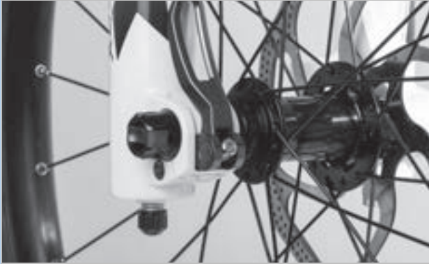
Rysunek 229: Ustawianie siły mocowania zacisku szybko mocującego
