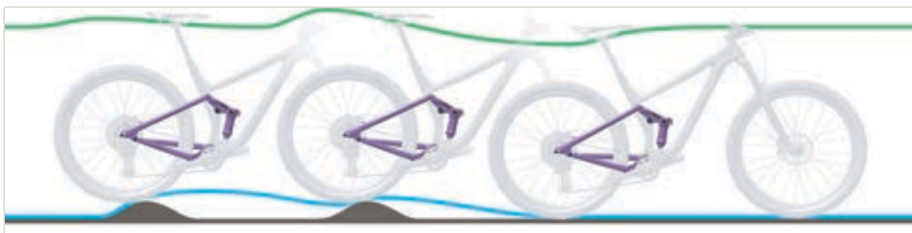
Rysunek 275: Zbyt wolne rozprężanie się tylnego amortyzatora
