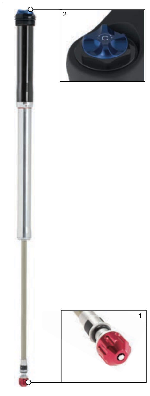
Rysunek 30: Elementy obsługi RC
