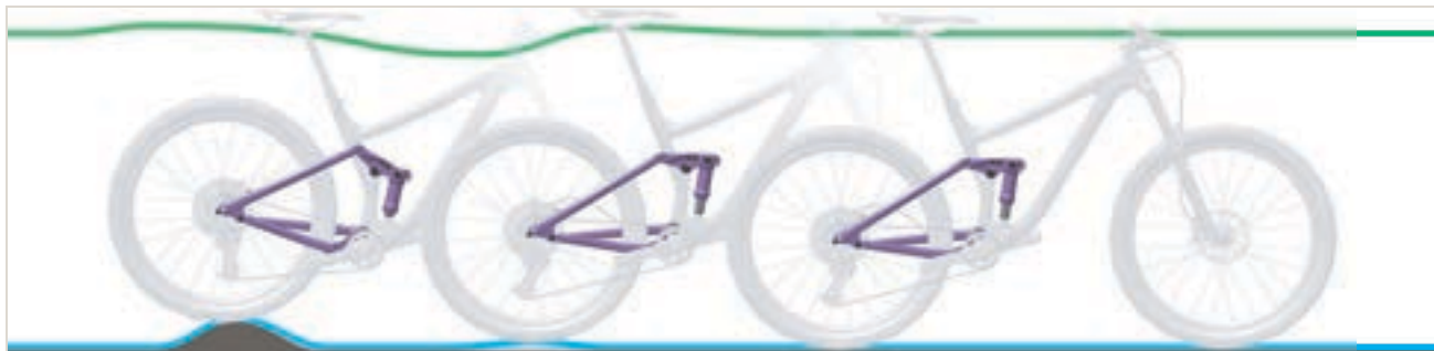
Rysunek 273: Zbyt szybkie rozprężanie się tylnego amortyzatora
