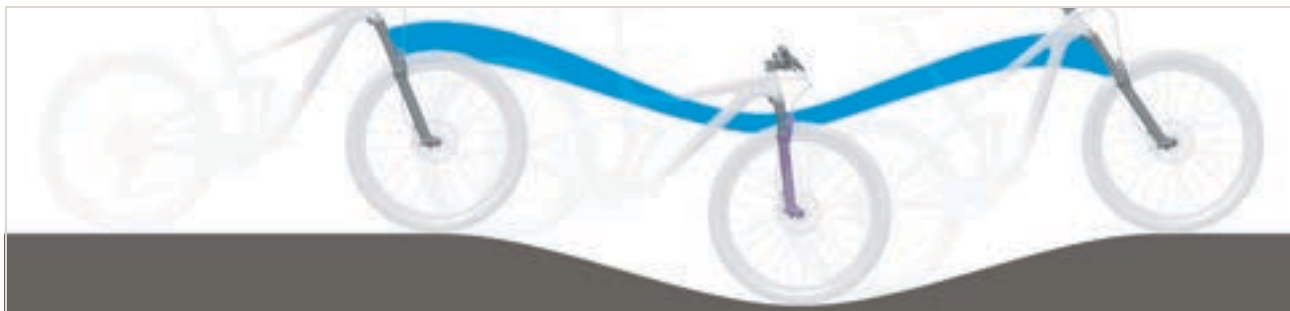
Rysunek 237: Zbyt miękkie amortyzowanie widelca na wzniesieniu
