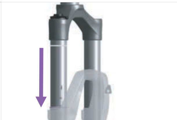
Rysunek 136: Przesuwanie pierścienia o-ring na widelcu amortyzowanym
