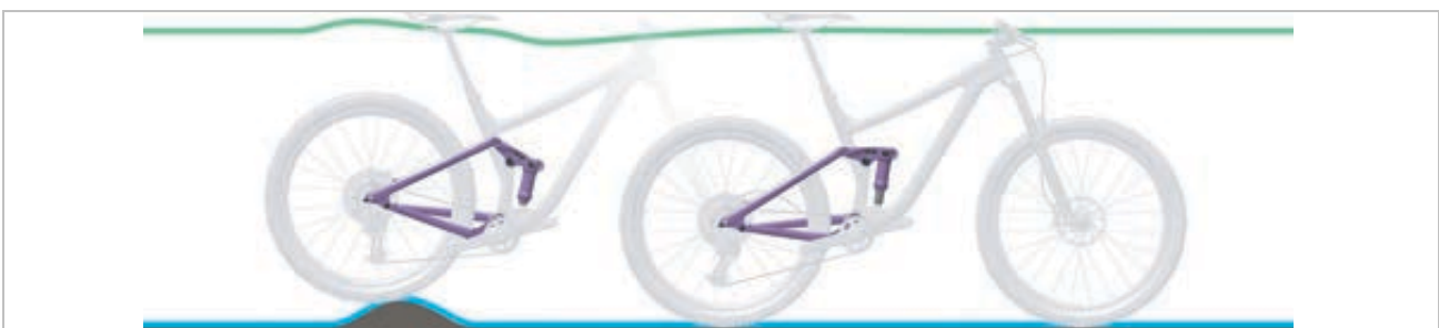
Rysunek 142: Optymalne działanie tylnego amortyzatora na nierównościach
