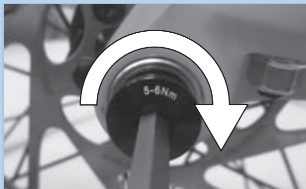
Rysunek 77: Sposób dokręcania śruby zabezpieczającej
