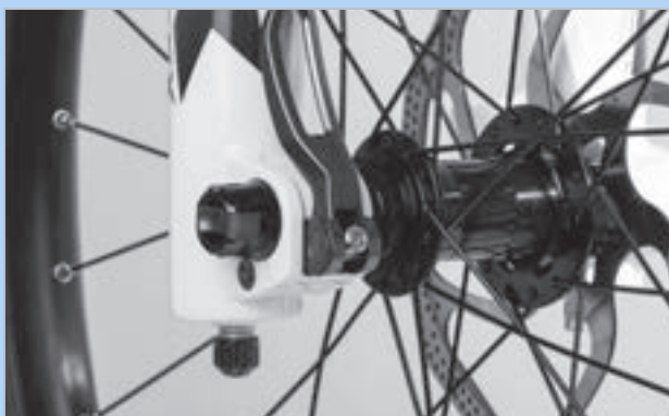
Rysunek 82: Optymalne położenie dźwigni mocującej
