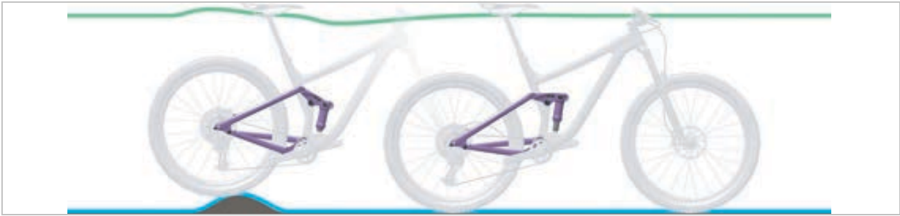
Rysunek 7: Optymalne działanie tylnego amortyzatora na nierównościach
