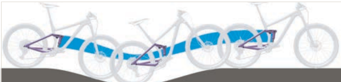
Rysunek 261: Zbyt miękkie amortyzowanie tylnego amortyzatora na wzniesieniu
