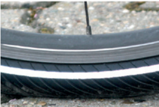
Rysunek 119: Prawidłowe ciśnienie w oponach. Opona prawie nie odkształca się pod wpływem masy ciała
