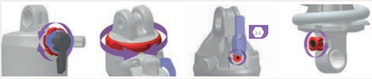
Rysunek 154: Pozycja i kształt nastawnika odbicia (tylnego amortyzatora) (kolor czerwony) zależą od modelu
