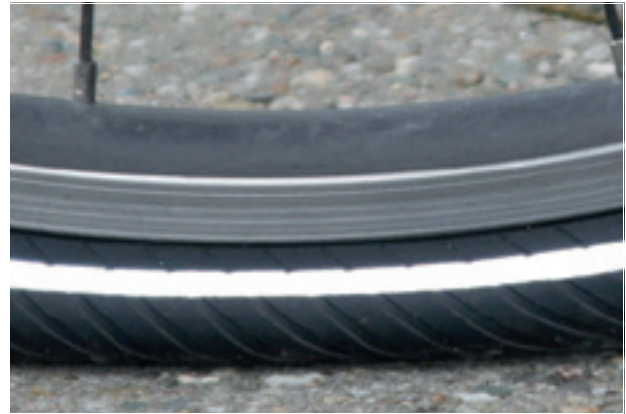
Rysunek 120: Zbyt niskie ciśnienie w oponie
