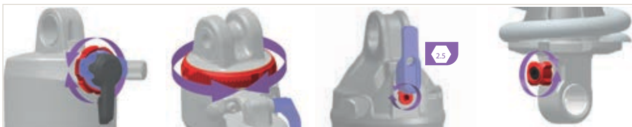
Rysunek 276: Pozycja i kształt nastawnika odbicia (kolor czerwony) zależy od modelu
