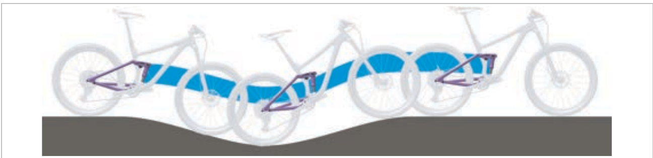
Rysunek 141: Optymalne działanie tylnego amortyzatora na pagórkowatym terenie
