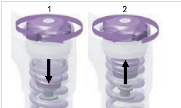
Rysunek 132: Dokręcanie (1) i odkręcanie (2) pokrętła regulacyjnego SAG
