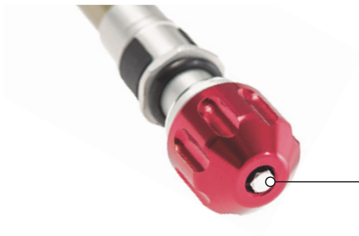
222 paveikslėlis. SR SUNTOUR atšokimo pakopos varžto pavyzdys (1)
