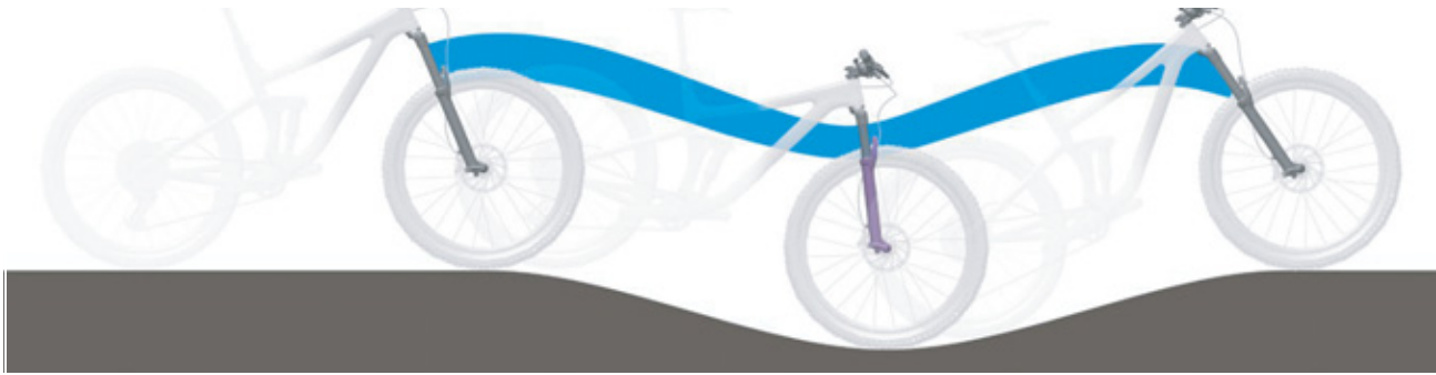
132 paveikslėlis. Optimali šakių važiavimo charakteristika kalvotoje vietovėje
