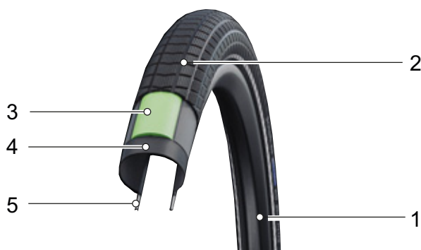
26 paveikslėlis. Atvirų padangų konstrukcija
