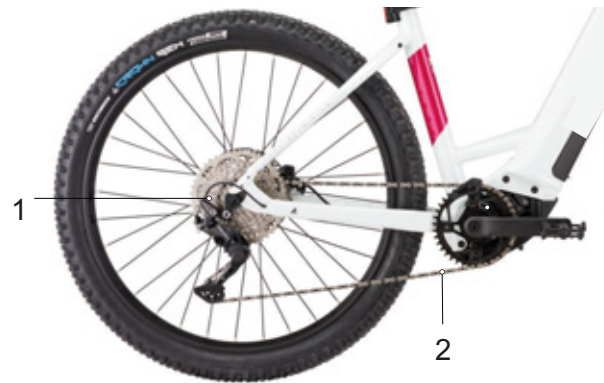
46 paveikslėlis. Grandininės pavaros su pavarų perjungikliu schema
