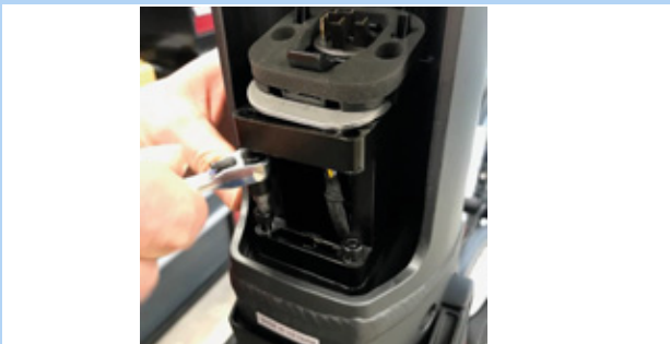
68 paveikslėlis. 4 mm šešiabriaunių varžtų nuėmimas
