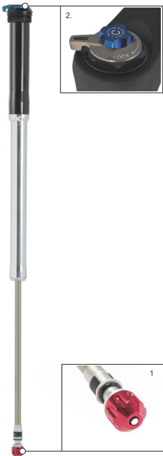
23 paveikslėlis. LORC-PCS valdymo elementai
