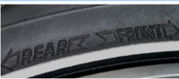
96 paveikslėlis. Krypties rodyklė ant MTB padangų
