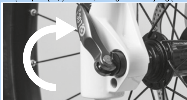
94 paveikslėlis. Ekscentriko uždarymas
