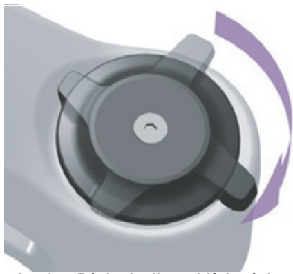
Illustration 94 : Régler le dispositif de réglage de la compression sur un niveau plus dur
