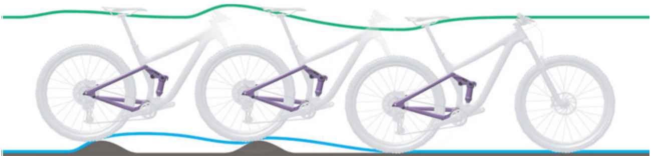
Illustration 99 : Détente trop lente de l'amortisseur arrière
