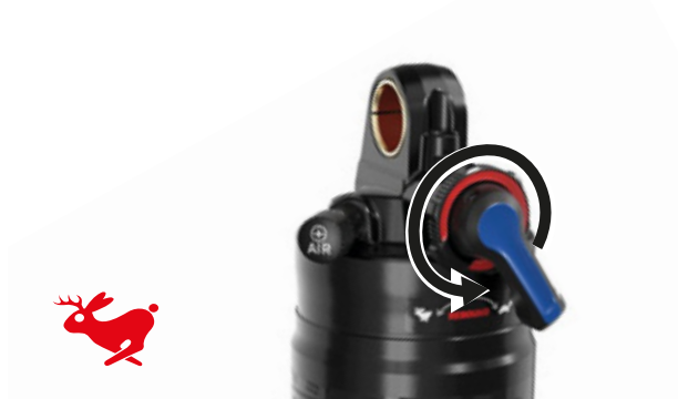
Illustration 67 : Augmenter la vitesse de détente
