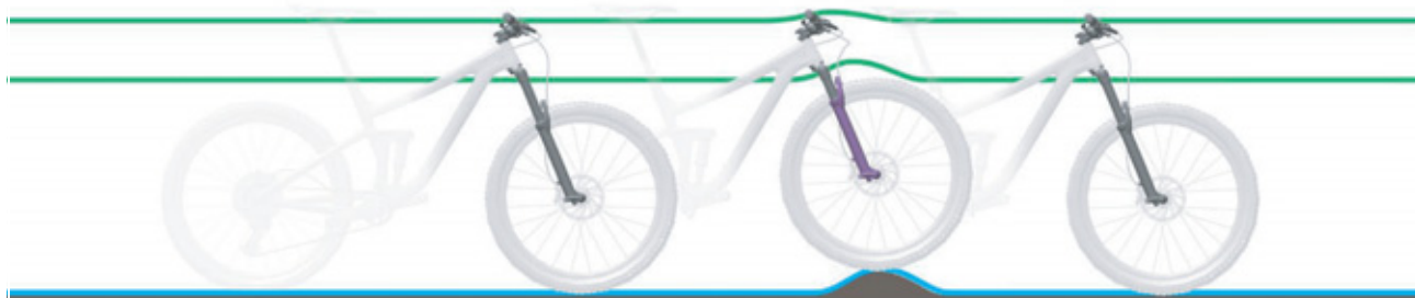
Illustration 7 : Comportement optimal de la fourche sur les irrégularités
