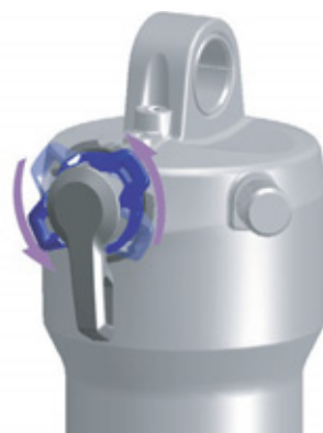
Illustration 72 : Régler le dispositif de réglage de la compression sur un niveau plus souple
