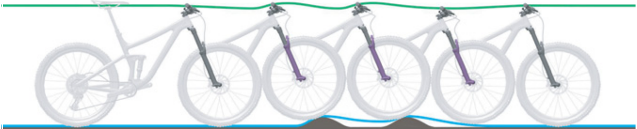
Illustration 91 : Détente trop lente de la fourche de suspension
