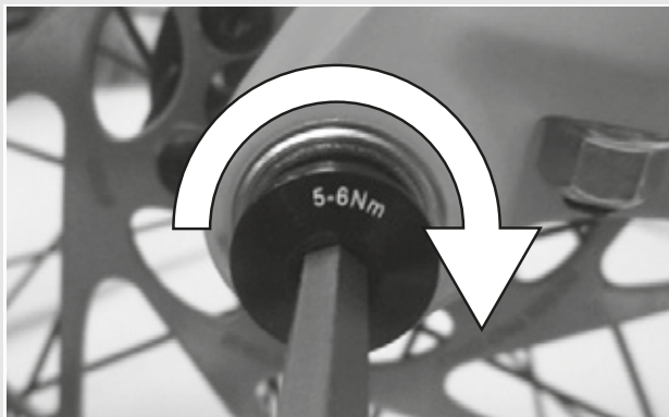
Illustration 25 : Serrer la vis de blocage
