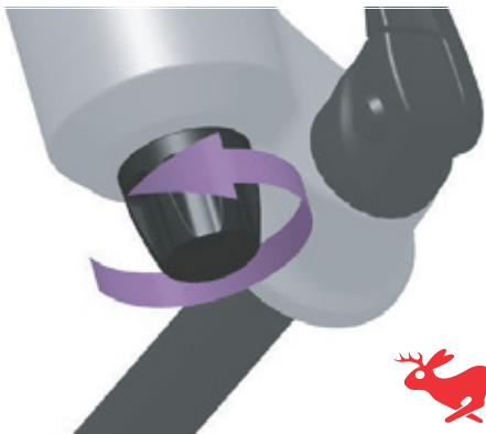
Illustration 92 : Tourner l'amortisseur de détente vers le lièvre
