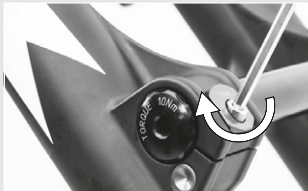
Illustration 27 : Serrer le collier de blocage
