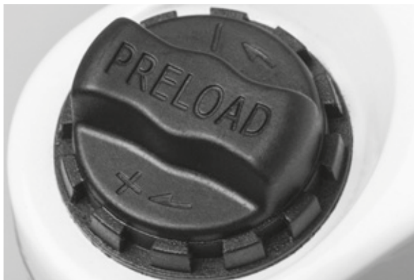
Illustration 53 : Molette de réglage du sag sur la couronne de la fourche de suspension
