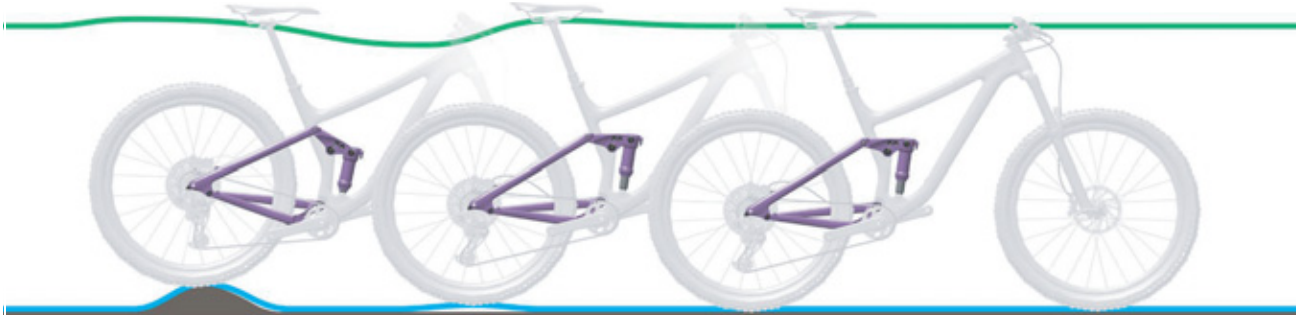
Illustration 97 : Détente trop rapide de l'amortisseur arrière
