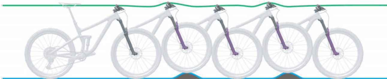
Illustration 5 : Comportement optimal de la fourche
