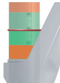
Illustration 58 : Plage de sag prescrite (vert) et plage de sag interdite
