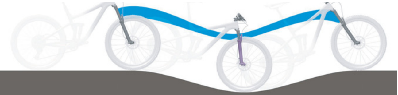
Illustration 93 : Suspension trop souple de la fourche de suspension dans les côtes
