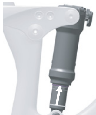
Illustration 60 : Déplacer le joint torique sur l'amortisseur arrière
