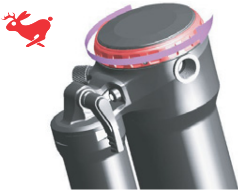
Illustration 100 : Tourner l'amortisseur de détente vers le lièvre
