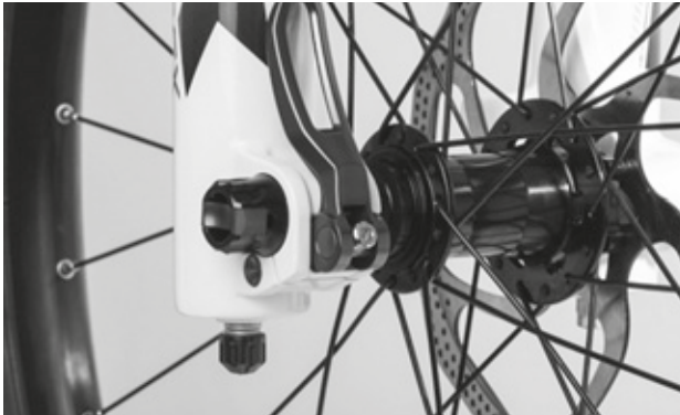
Illustration 84 : Régler la force de serrage de l'attache rapide
