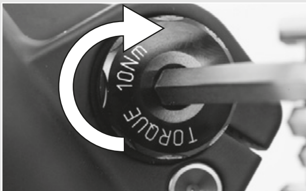
Illustration 26 : Serrer l'axe inséré
