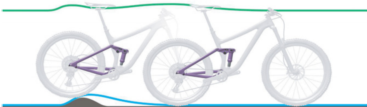
Illustration 103 : Amortissement trop dur de l'amortisseur arrière en cas d'irrégularités
