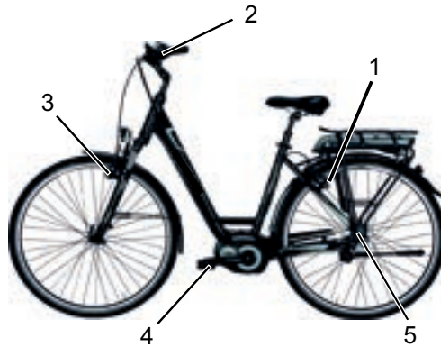
Abbildung 8: Bremssystem eines Fahrrads mit einer Rücktrittbremse, Beispiel
