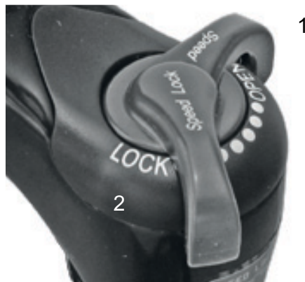
Abbildung 55: Suntour-Druckstufeneinsteller mit den Positionen OPEN (1) und LOCK (2)
