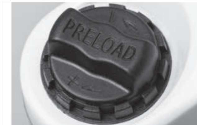
Abbildung 47: Einstellrad des Negativen Federwegs auf der Krone der Federgabel
