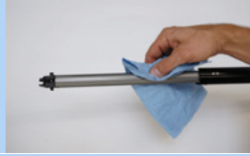
198. ábra: Hosszirányú vezetőhorny tisztítása
