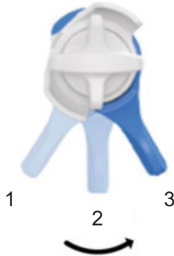
97. ábra: A 3-utas kar beállítása zárt (1) helyzetből középhezleten (2) át nyitva (3) helyzetig
