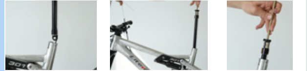
173. ábra: Tubus szelepfedél rögzítése
