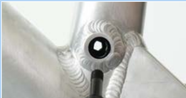
205. ábra: A Postpin csatlakozás nyílása
