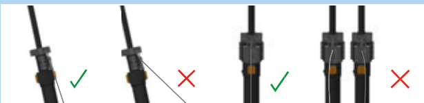
172. ábra: Helyesen és hibásan beállított bovdent
