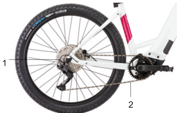
32. ábra: Külső váltóval felszerelt lánchajtás vázlata
