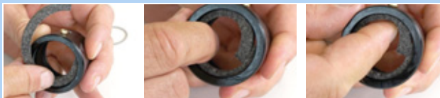
158. ábra: Filcgyűrű behelyezése
