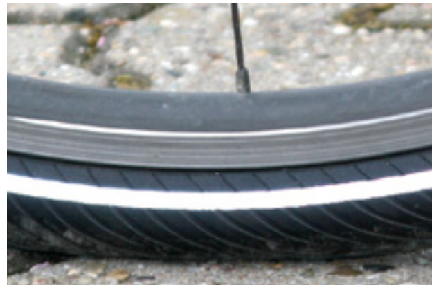
83. ábra: Helyes töltőnyomás. A gumiabroncs alakja a testsúly terhe alatt alig változik
