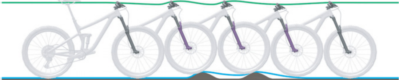
217. ábra: A teleszkópos villa túl lassú kirugózása
