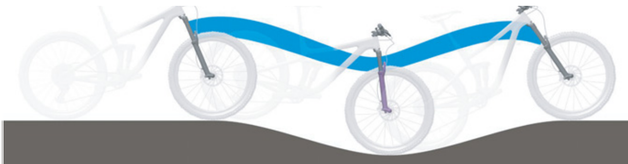
9. ábra: A villa optimális menetviselkedése dombos terepen
