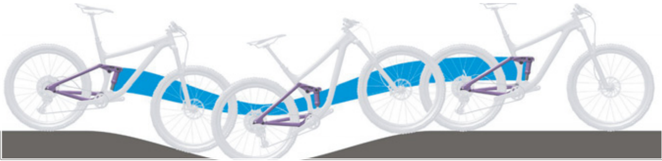
229. ábra: A hátsó lengéscsillapító túl puha rugózása hegymenetben
