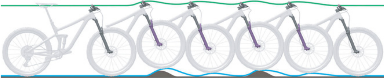
207. ábra: A teleszkópos villa túl gyors kirugózása
