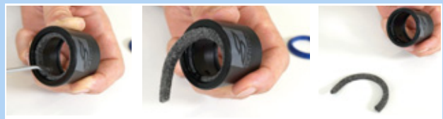
156. ábra: A filcgyűrű eltávolítása
