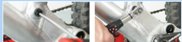
175. ábra: Postpin tengely rögzítése
