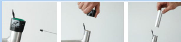
187. ábra: Külső hüvely és siklópersely kiszérése
