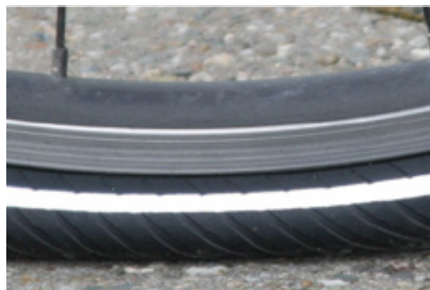
Figura 75: Pressione di gonfiaggio insufficiente
