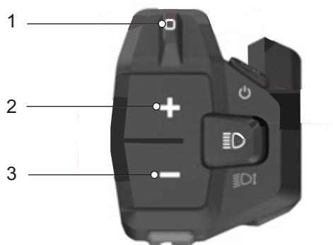
Figura 91: Ubicazione interruttore a bilico (1), pulsante più (2) e pulsante meno (3)
