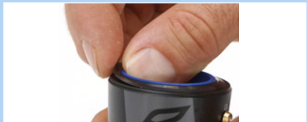
Figura 173: Estrazione dell'anello a labbro di tenuta
