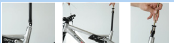
Figura 158: Fissaggio del coperchio della valvola della cartuccia
