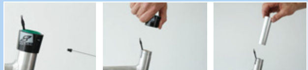
Figura 172: Smontaggio della boccola esterna e del manicotto scorrevole
