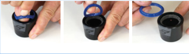
Figura 175: Estrazione del parapolvere
