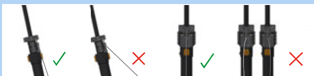
Figura 157: Cavo meccanico corretto ed errato
