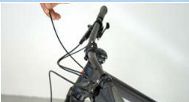
Figura 189: Aggancio del cappuccio terminale
