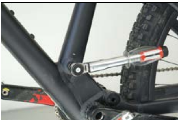
Figura 58: Serraggio dell'asse del canotto reggisella
