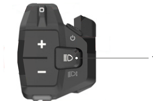
Figura 103: Ubicazione del pulsante luce di marcia
