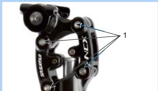
Figura 129: Punti di lubrificazione del cannotto reggisella ammortizzato SR Suntour
