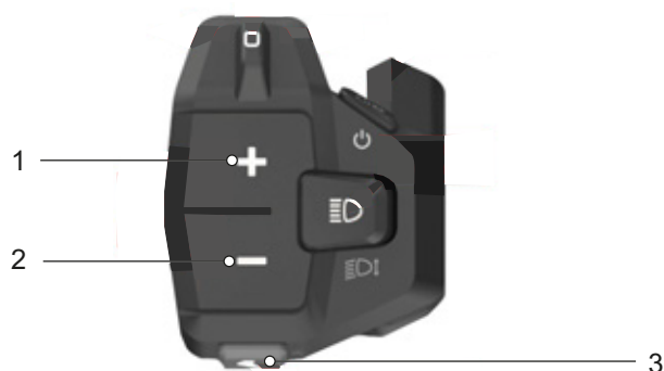
Figura 104: Ubicazione pulsante più (1), pulsante meno (2) e pulsante della funzione di assistenza di spinta (3)
