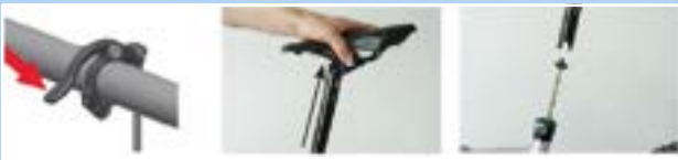
Figura 131: Estrazione del cannotto reggisella
