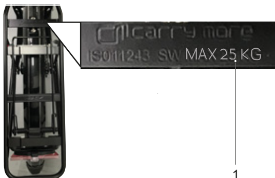
Figura 98: Sul portapacchi è indicata la sua portata massima (1).
