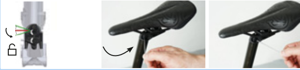
Figura 130: Posizionamento dell'azionamento della regolazione in altezza in posizione orizzontale
