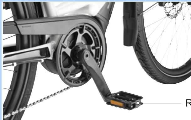
Figura 78: Pedal R en el brazo de manivela derecho
