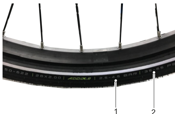
Figura 134: Presión de inflado en bar (1) y psi (2)
