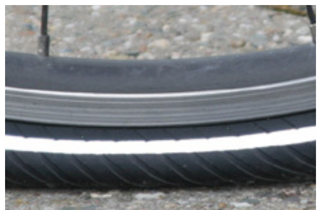
Figura 98: Presión de inflado demasiado baja
