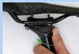
Figura 204: Cierre del ajuste de altura
