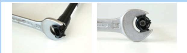
Figura 169: Aseguramiento para evitar el giro
