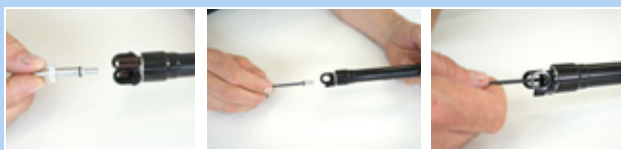
Figura 167: Fijación la tapa de la válvula del cartucho
