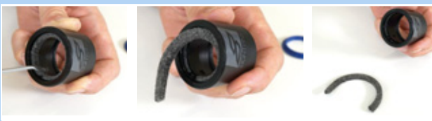
Figura 194: Retirada del anillo de fieltro
