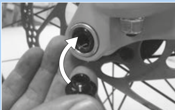
Figura 64: Inserción de la palanca de cierre rápido en el eje
