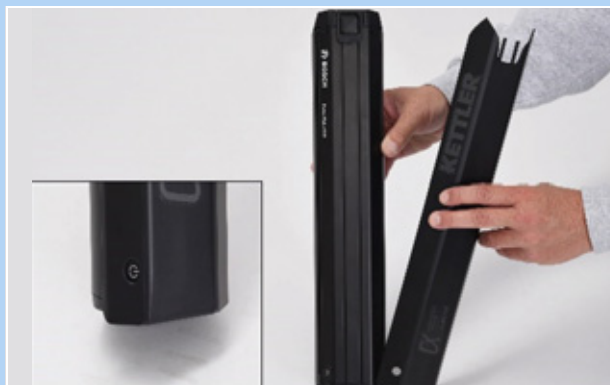
Figura 55: Desplazamiento de la cubierta de la batería sobre la batería
