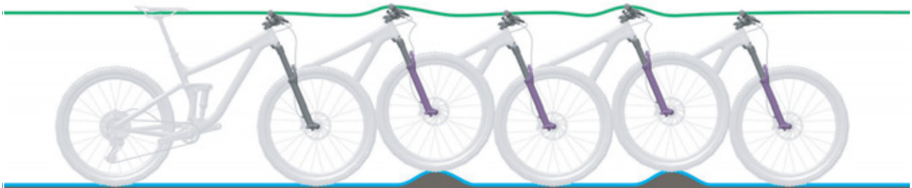
Figura 11: Condición óptima de marcha de la horquilla
