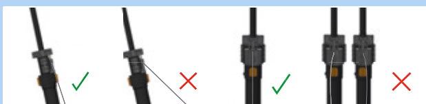
Figura 175: Cable Bowden correcto e incorrecto
