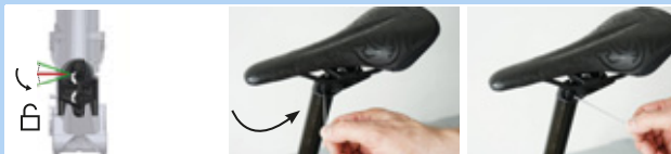
Figura 148: Colocar el accionamiento del ajuste de altura en la "Posición abierta"
