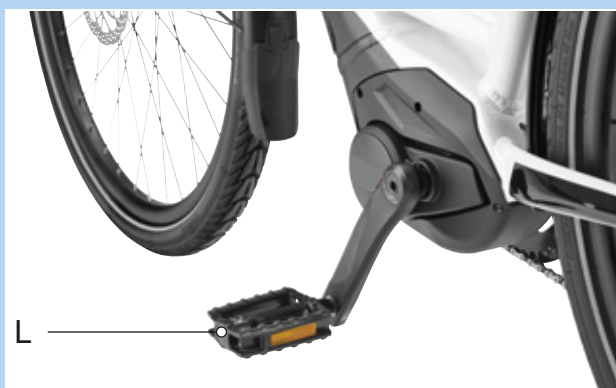
Figura 77: Pedal L en el brazo de manivela izquierdo
