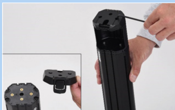
Figura 58: Atornillamiento de la placa de montaje de la batería
