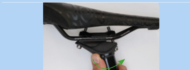
Figura 199: Apertura del ajuste de altura
