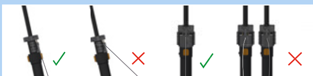
Rysunek 172: Prawidłowa i nieprawidłowa pozycja cięgna Bowdena
