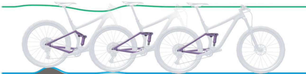
Rysunek 225: Zbyt szybkie rozprężanie się tylnego amortyzatora
