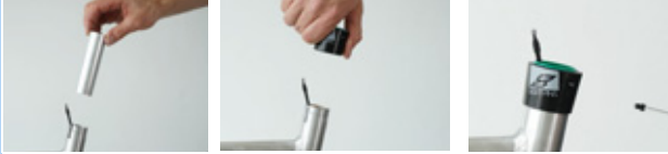
Rysunek 202: Montaż tulei ślizgowej i tulei zewnętrznej
