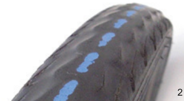
Rysunek 132: Opona bez bieżnika, która jeszcze nadaje się do jazdy (1) i opona z prześwitującą ochroną przed przebicciem (2), którą należy wymienić
