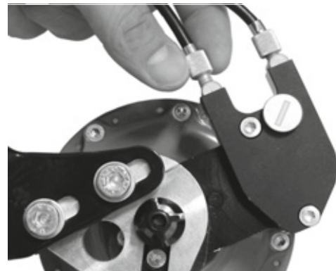
Rysunek 138: Wersje piast Rohloff z zewnętrznym sterowaniem zmiany biegów mają regulator linki na przepustnicy kablowej, która znajduje się po lewej stronie
