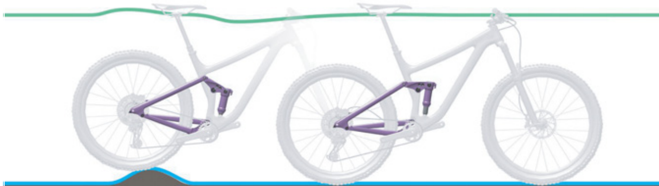
Rysunek 96: Optymalne działanie tylnego amortyzatora na nierównościach
