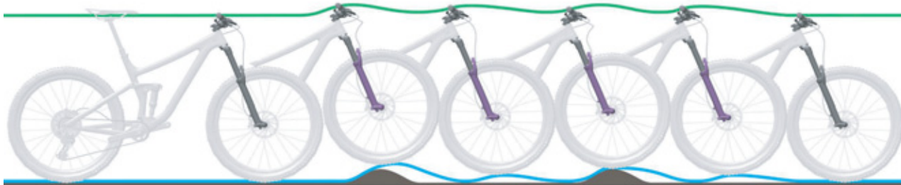
Rysunek 207: Zbyt szybkie rozprężanie widelca amortyzowanego
