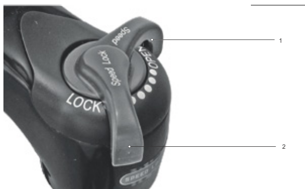
Rysunek 212: Ustawienie nastawnika dobiecia na twardszy tryb pracy
