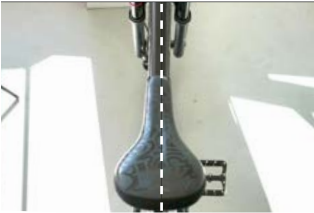
Rysunek 66: Ustawianie siodełka zgodnie z kierunkiem jazdy
