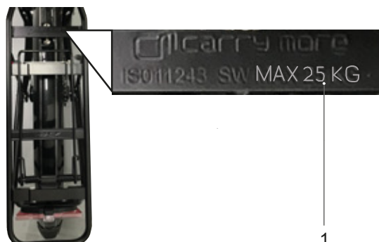
Rysunek 112: Na bagażniku umieszczona jest informacja o jego maksymalnej nośności (1)
