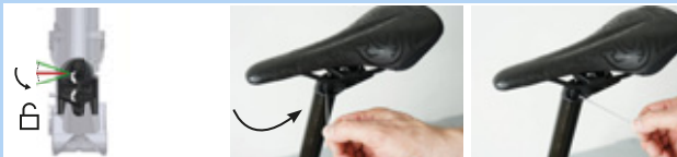
Rysunek 145: Ustawianie mechanizmu regulacji wysokości w pozycji „otwartej”.
