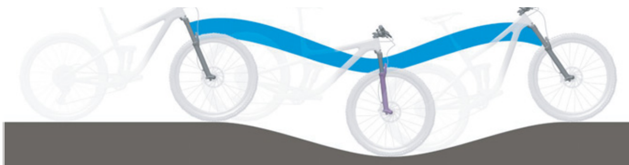
Rysunek 9: Optymalne działanie widełca na pagórkowatym terenie
