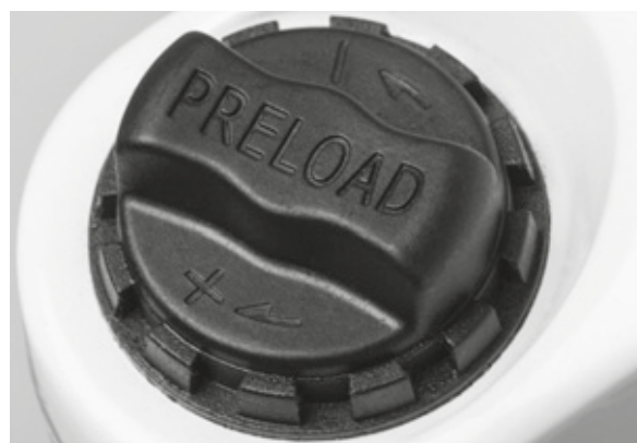
Illustration 70 : Molette de réglage de la course de suspension négative sur la couronne de la fourche de suspension
