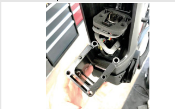
Illustration 29 : Retirer l'adaptateur PowerTube
