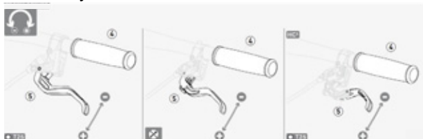
Illustration 68 : Régler la garde d'un levier de frein à disque Magura
