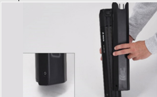
Illustration 38 : Enfoncer le capot de batterie sur la batterie
