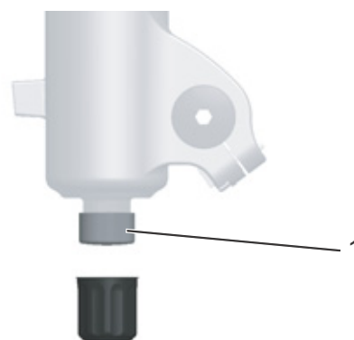
Illustration 73 : Dispositif de réglage de la détente FOX (1) sur l'extrémité de fourche
