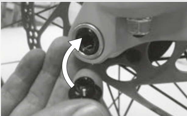
Illustration 41 : Enfoncer le levier d'attache rapide dans l'axe
