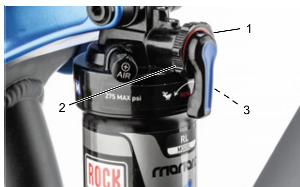
Illustration 88 : Régler la dureté de l'amortisseur de détente via la molette de réglage (1) de l'amortisseur arrière
