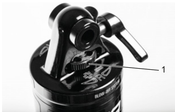
Illustration 74 : Molette de réglage de la détente Suntour (1) sur l'amortisseur arrière
