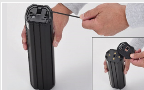
Illustration 32 : Démontage de l'interface supérieure
