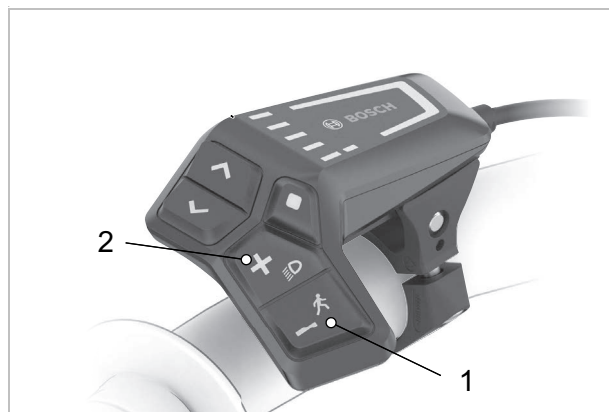
Abbildung 330: Lage Plus-Taster und Minus-Taster
