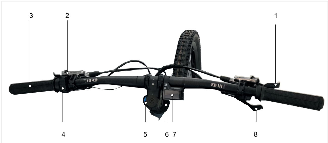
Abbildung 157: Detailansicht Lenker mit SHIMANO SC-E800 Bordcomputer, Beispiel
