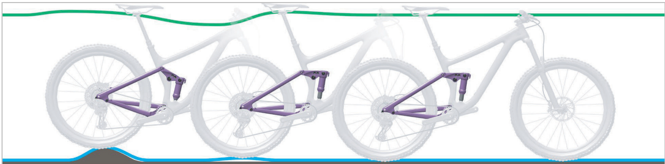
Abbildung 510: Zu schnelles Ausfedern des Hinterbau-Dämpfers
