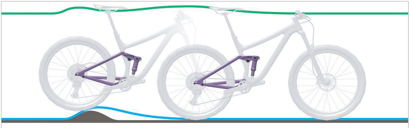
Abbildung 516: Zu harte Dämpfung des Hinterbau-Dämpfers bei Unebenheiten
