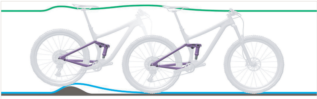
Abbildung 532: Zu harte Dämpfung des Hinterbau-Dämpfers bei Unebenheiten
