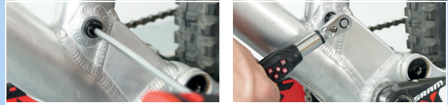
Abbildung 445: Postpin Achse befestigen
