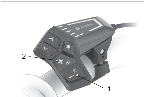
Abbildung 335: Lage Plus-Taster und Minus-Taster
