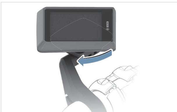
Abbildung 278: Bildschirm im Uhrzeigersinn drehen
