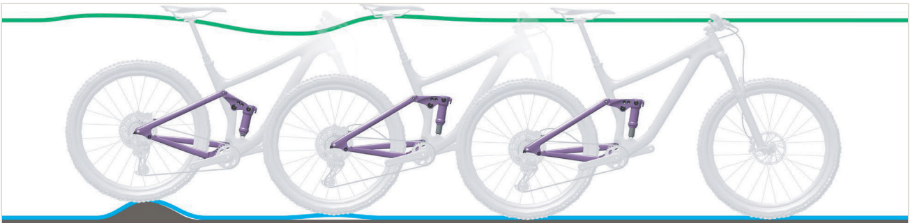
Abbildung 518: Zu schnelles Ausfedern des Hinterbau-Dämpfers
