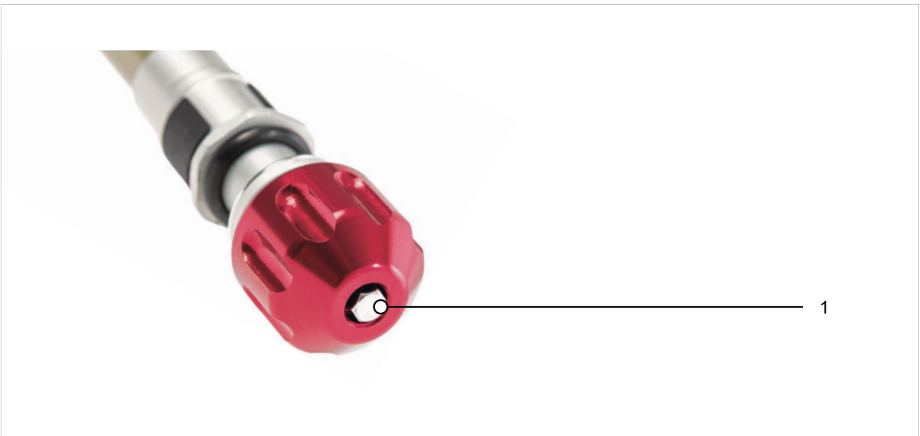
Abbildung 489: Beispiel SR SUNTOUR Zugstufen-Einsteller (Federgabel) (1)
