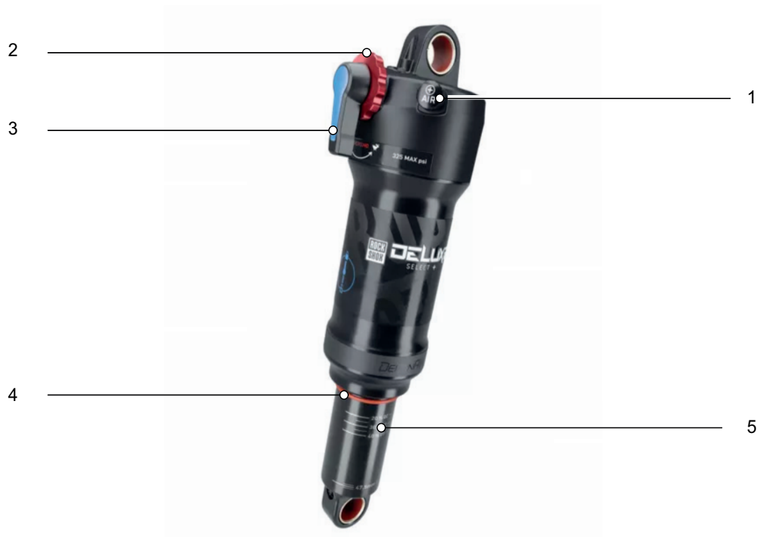
Abbildung 11: Aufbau ROCKSHOX Deluxe Select+ Hinterbau-Dämpfer
