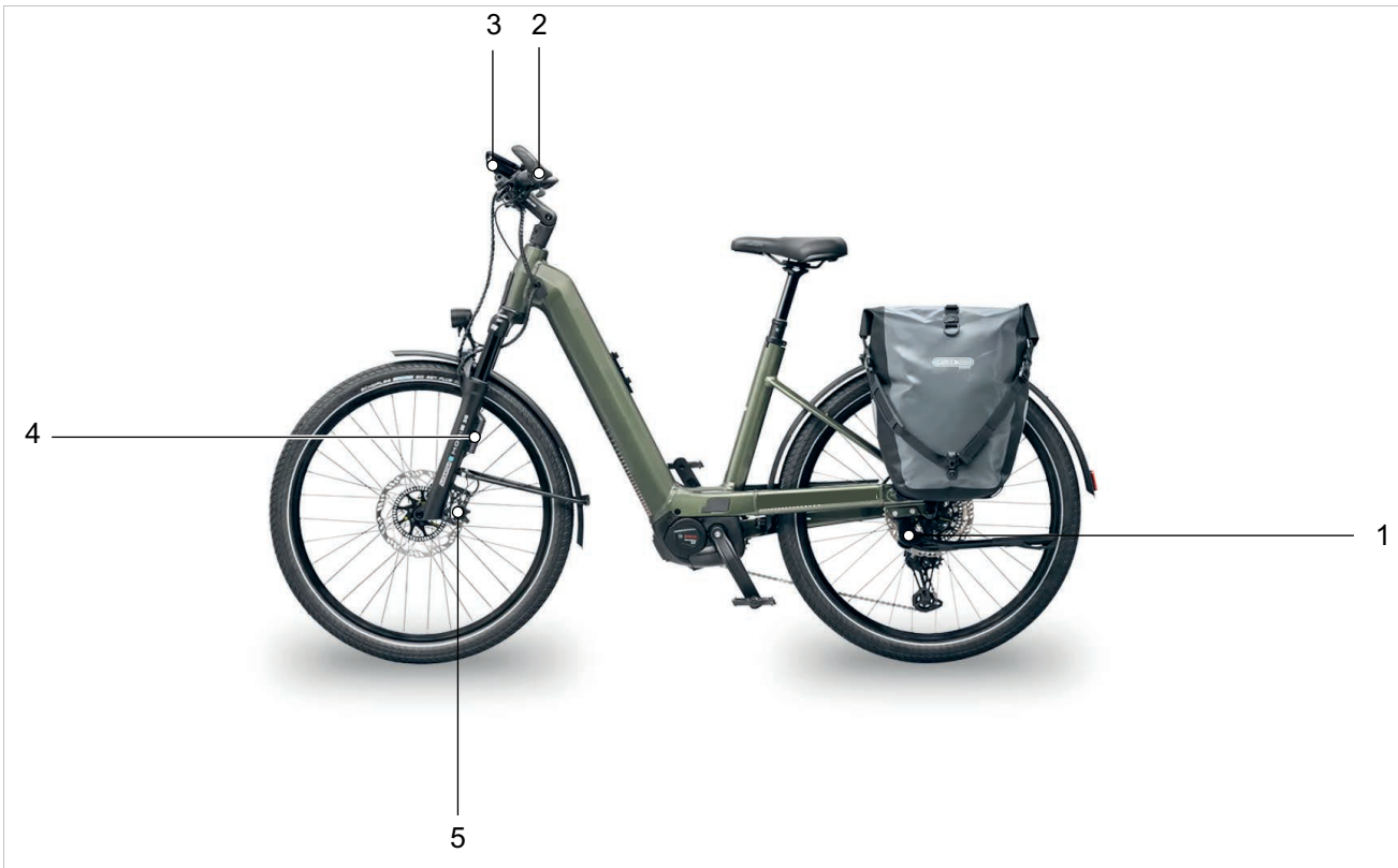
Abbildung 56: Komponenten BOSCH ABS
