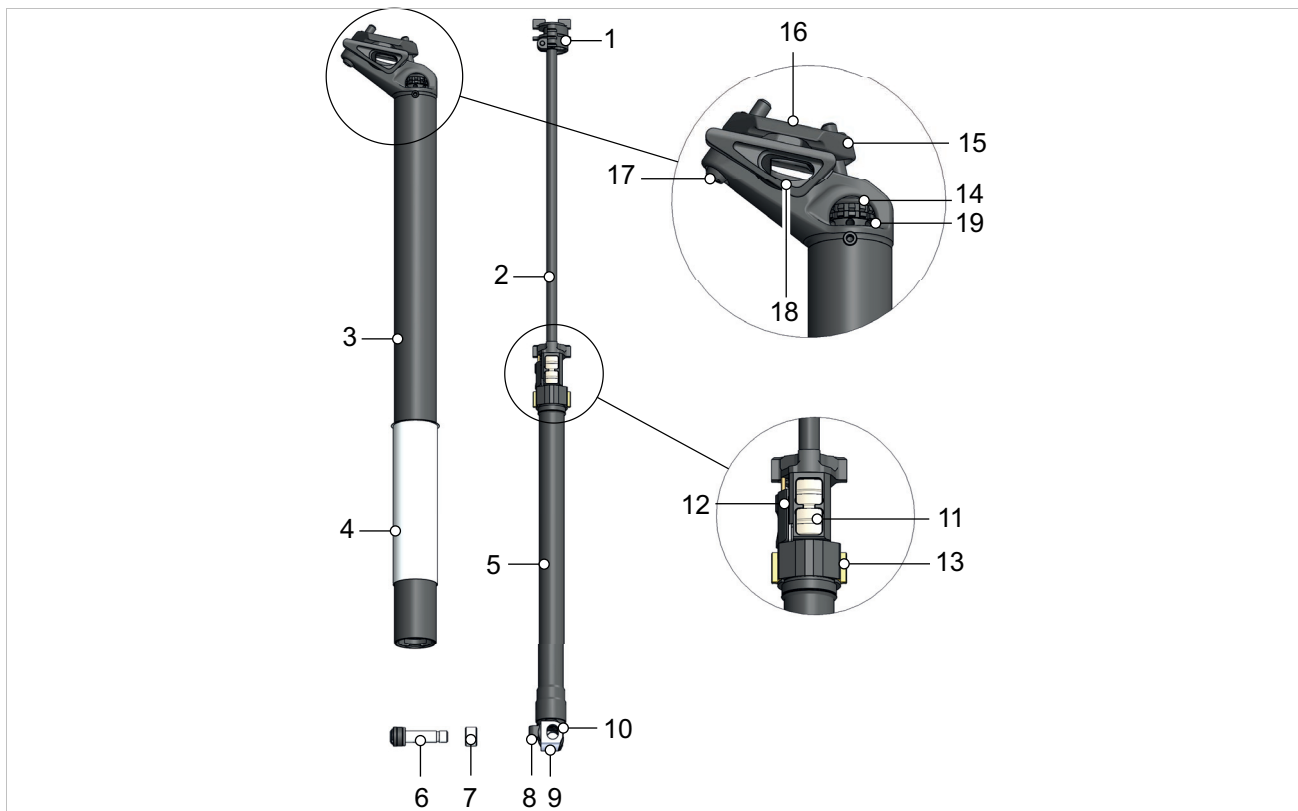
Abbildung 69: Aufbau 8Pins Sattelstütze
