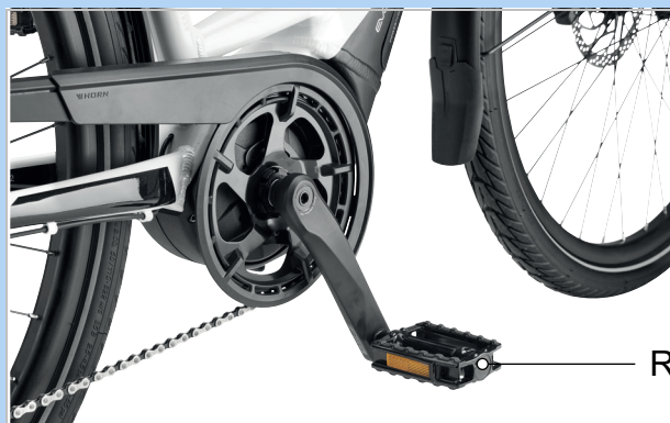
Abbildung 201: R-Pedal im rechten Kurbelarm
