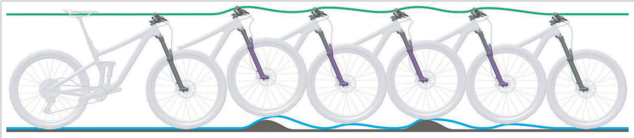
Abbildung 486: Zu schnelles Ausfedern der Federgabel
