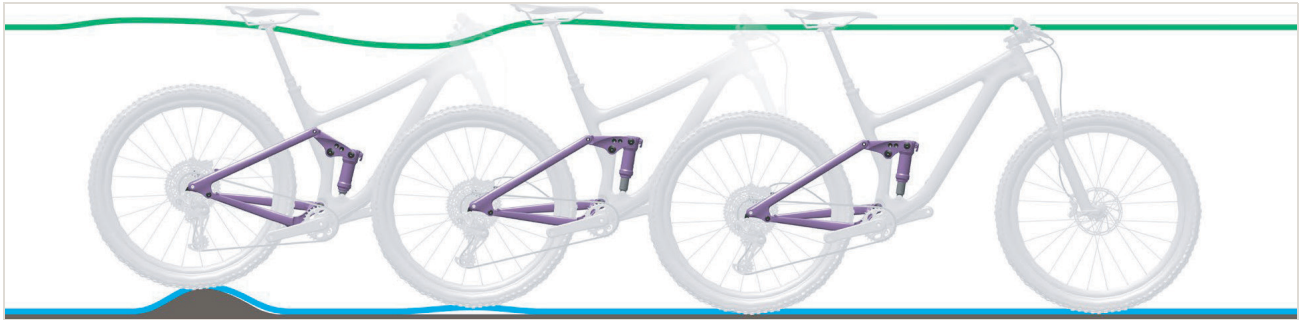
Abbildung 526: Zu schnelles Ausfedern des Hinterbau-Dämpfers
