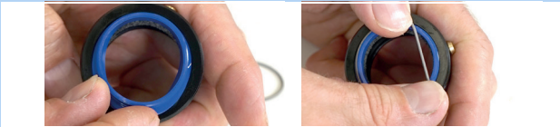
Abbildung 429: Abstreifer einlegen und befestigen
