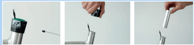
Abbildung 457: Außenhülle und Gleitbuchse ausbauen
