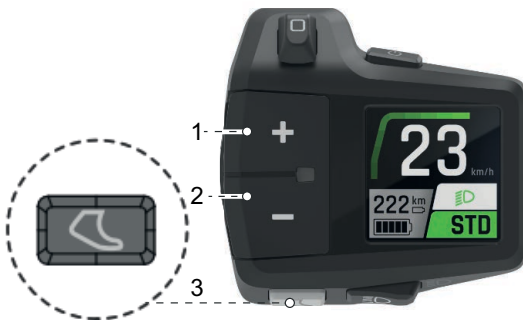
Abbildung 346: Lage Plus- (1), Minus- (2), und Schiebehilfe- (3) Taste
