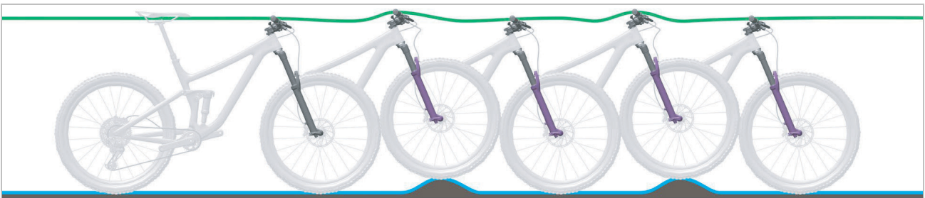
Abbildung 26: Optimales Fahrverhalten der Federgabel
