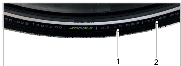
Abbildung 380: Angabe Fülldruck in bar (1) und psi (2)
