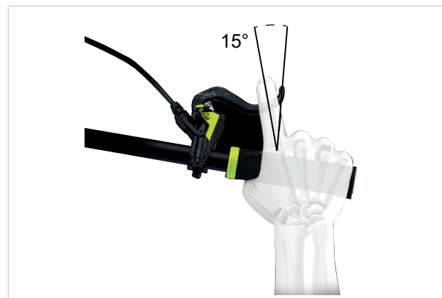
Abbildung 227: Position der Handbremse
