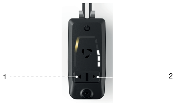
Abbildung 348: Lage Unterstützung-erhöhen-(1) und Unterstützung-verringern (2) Taste
