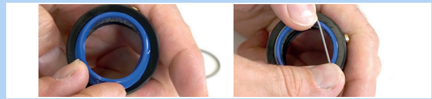
Abbildung 464: Abstreifer einlegen und befestigen
