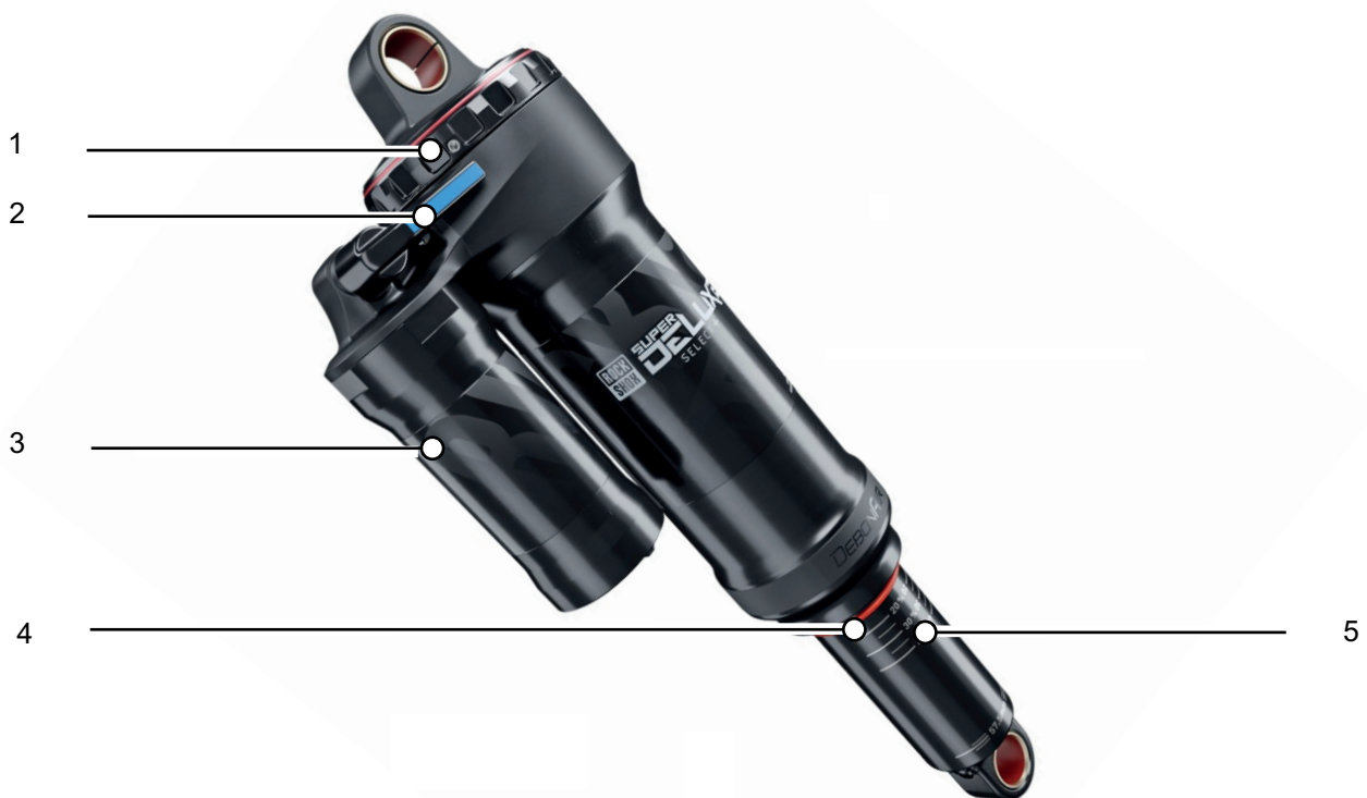
Abbildung 13: Aufbau ROCKSHOX Super Deluxe Select+ Hinterbau-Dämpfer
