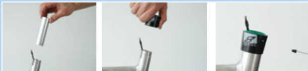
204 paveikslėlis. Sumontuokite slankiąją įvorę ir išorinę movą
