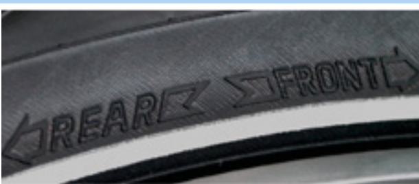
68 paveikslėlis. Krypties rodyklė ant MTB padangų
