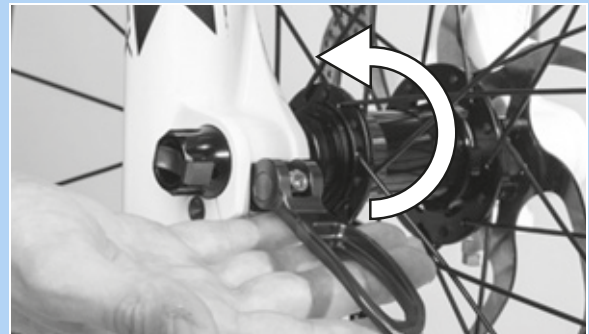
60 paveikslėlis. Spauskite greito atleidimo svirtį rodyklės kryptimi
